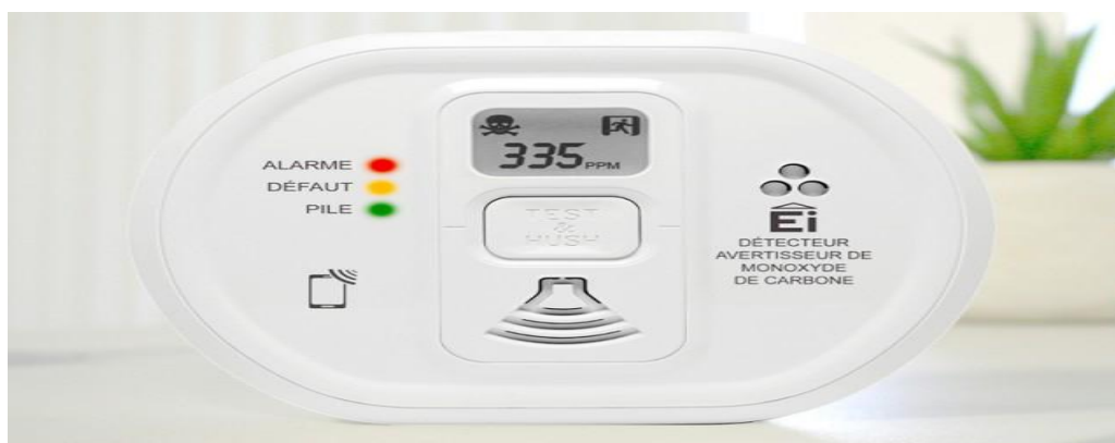
Figure 12 : détecteur de monoxyde de carbone électronique [27].
