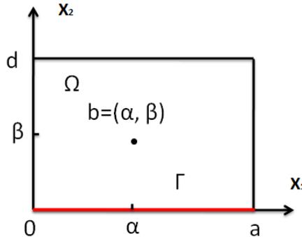
Figure10 : [8] L'emplacement de l'actionneur dans le cas ponctuel interne ( $b = (\alpha, \beta)$ ).
