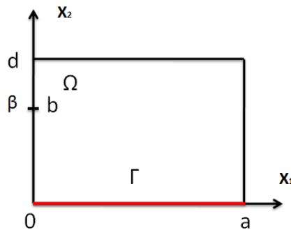
Figure 9 : [8] L'emplacement de l'actionneur dans le cas ponctuel frontière ( $b = (0, \beta)$ ).
