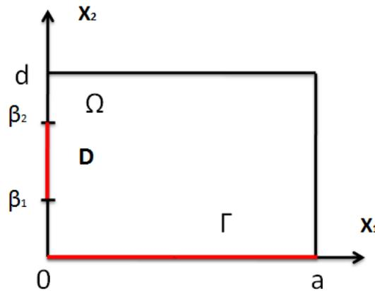
Figure12 : [8] L'emplacement de l'actionneur dans le cas zone frontière ( $D = \{0\} \times ]\beta_1, \beta_2[$ ).
