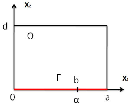
Figure 8 : [8] L'emplacement de l'actionneur dans le cas ponctuel frontière ( $b = (\alpha, 0)$ ).
