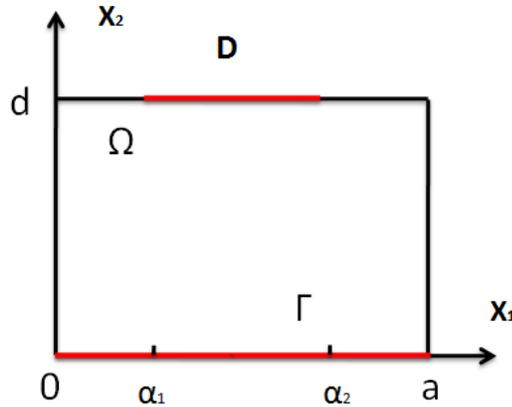
Figure11 : [8] L'emplacement de l'actionneur dans le cas zone frontière ( $D = ]\alpha_1, \alpha_2[ \times \{d\}$ ).
