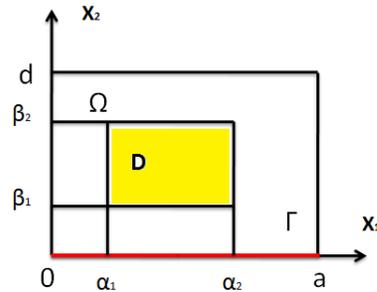
Figure13 : [8] L'emplacement de l'actionneur dans le cas zone interne
