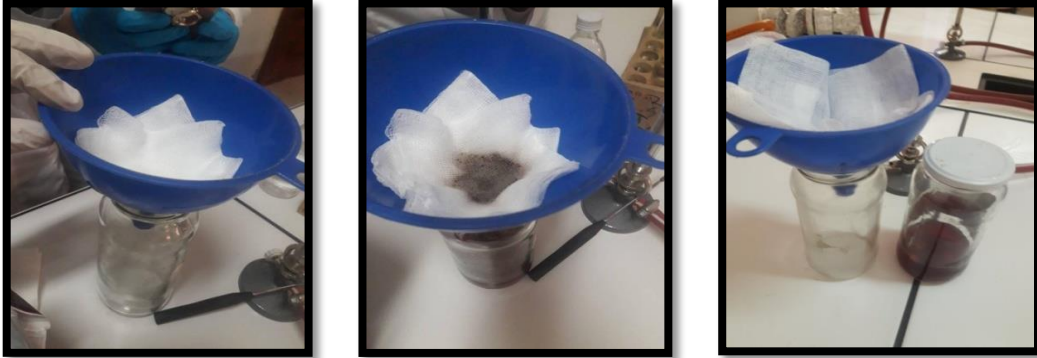
Figure09 : les étapes de filtration du prélèvement
