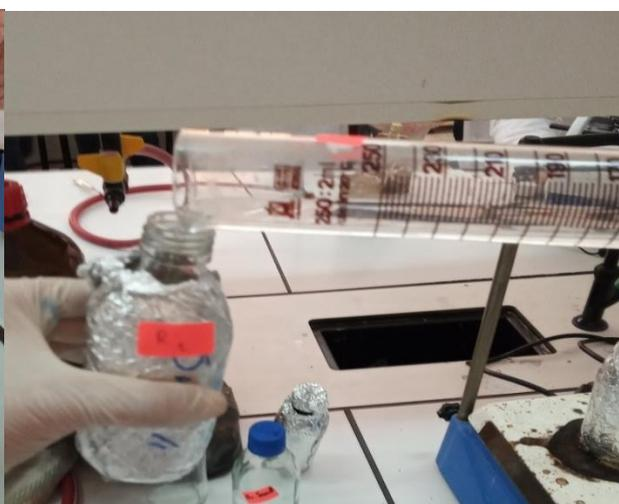
C- Mettre la MV sur 50 ml du méthanol aqueux bouillant (70:30)
