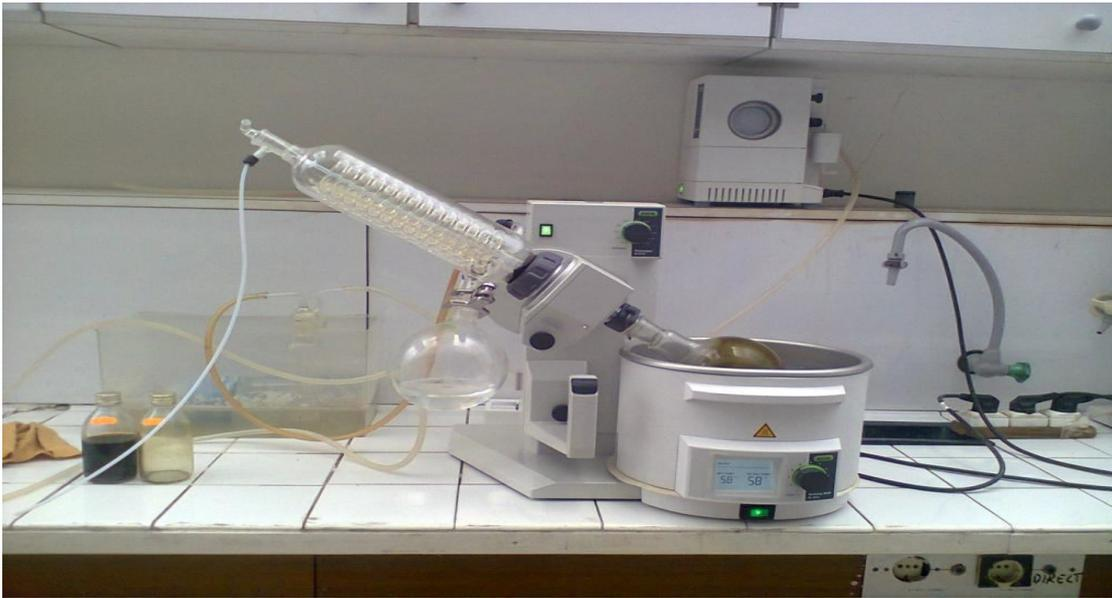
**Figure 11 : Photographie représentant un appareil Rotavapor.**
