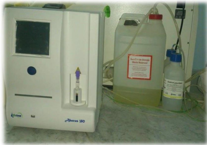
Figure 15 : Un automate d'Abacus 380 à 19 paramètres.
