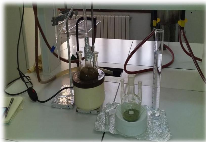
**Figure 10 :**Dispositif d'extraction des huiles essentielles de type cleverger+flacon (laboratoire de microbiologie appliquée,2021)
