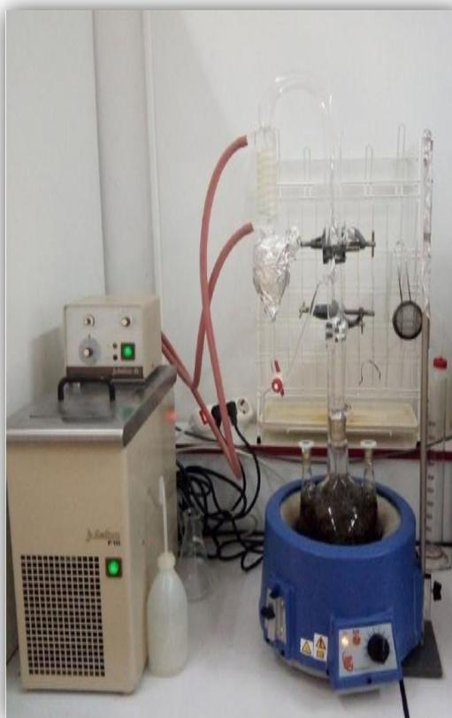
**Figure 10:** Montage de l'hydrodistillateur de type Clevenger (Original, 2020).
