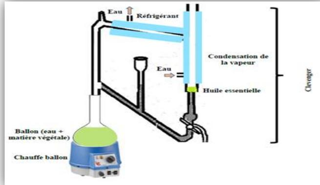
Figure 4: Appareil d'extraction type clevenger (Boucekrit, 2018).
