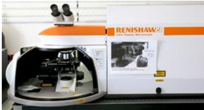
Figure II.8: Dispositif expérimental de la rétrodiffusion ( \mu -Raman).
