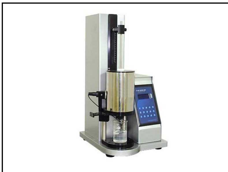
Figure II.4: Dispositif expérimental de trempage-tirage utilisé au Laboratoire Couches Minces et Interfaces de l'université de Constantine I.
