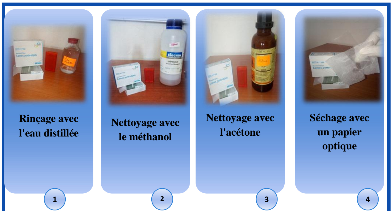
Figure II.1 : les étapes de nettoyage de substrat.
