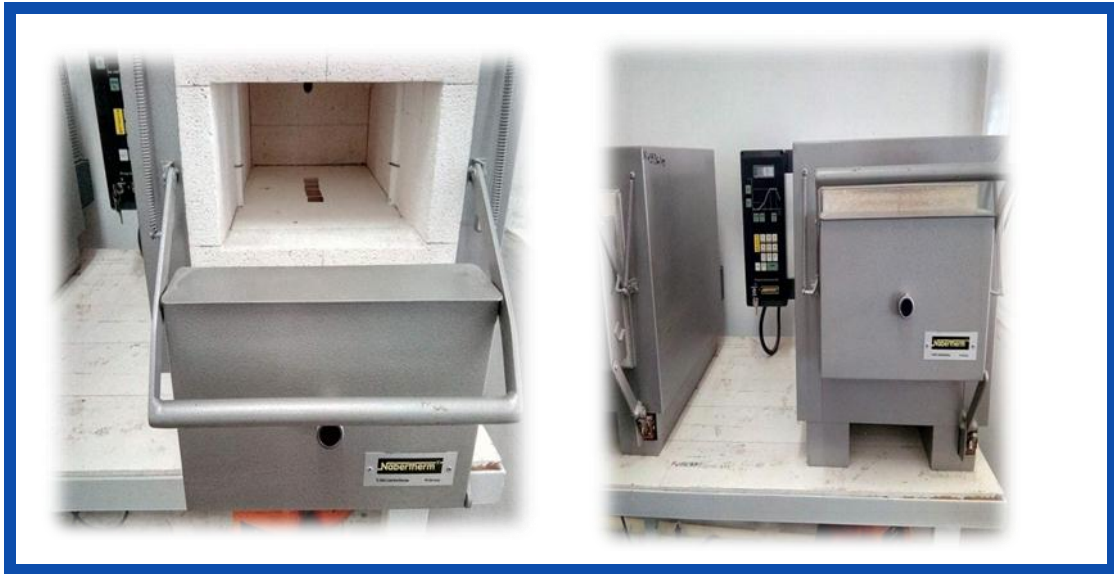
Figure II.5 : Le four utilisé pour le recuit.
