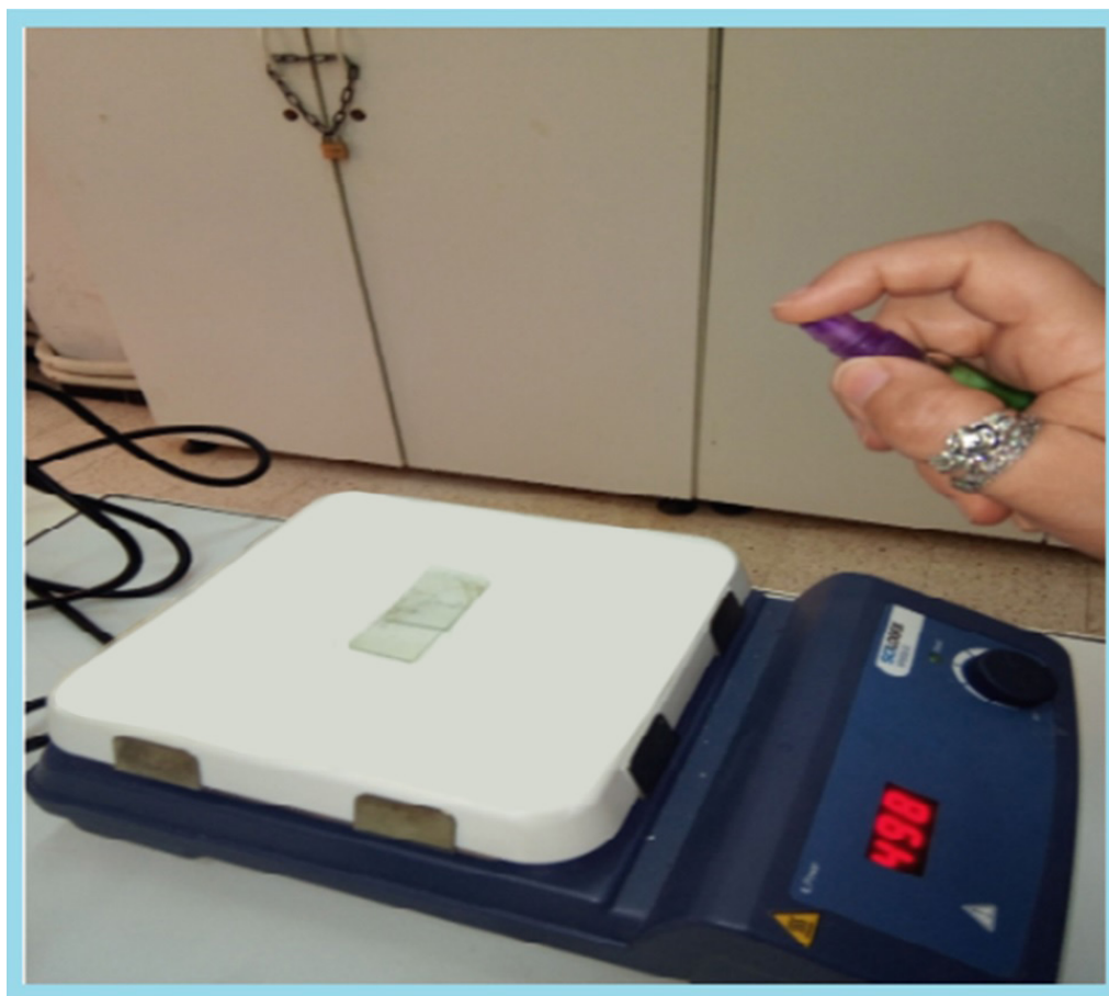
Figure II.1 : Dispositif expérimental utilisé de la technique de spray pyrolyse.
