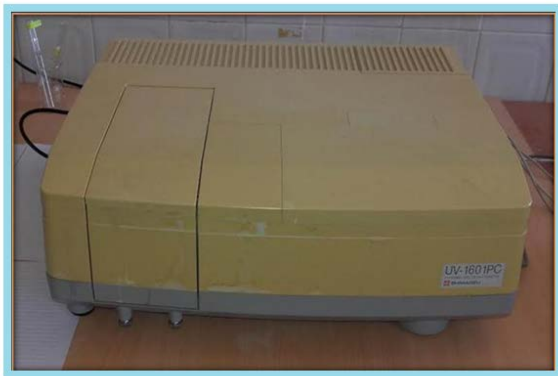
Figure II.8 : Photo du dispositif de la spectroscopie UV-visible utilisé (Laboratoire des matériaux organiques et hétérochimie .Université Larbi Tébessi. Tébessa).
