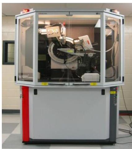
*Figure II.4 : Diffractomètre de type (BRUKER - AXS type D8) [28].*
