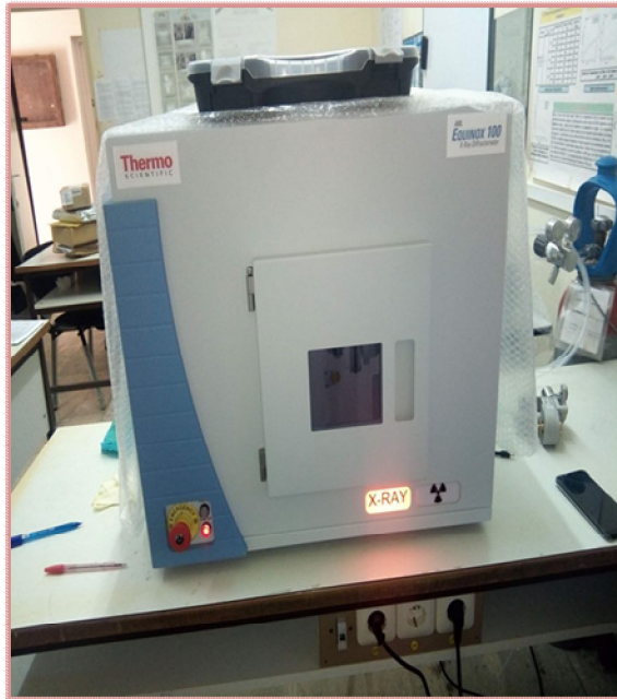
Figure II.5: Photographie du diffractomètre de rayons X utilisé pour la caractérisation de nos échantillons(laboratoire des matériaux et structure des systèmes électromécaniques et leur fiabilité Oum El –Bouaghie) .
