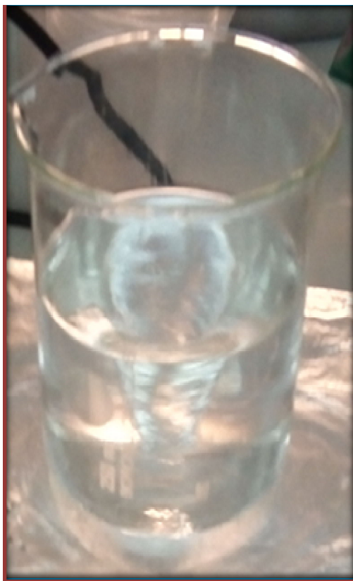
Figure II.3 : Dissolution de l'acétate de zinc dans le méthanol après l'agitation magnétique (solution de spray)
