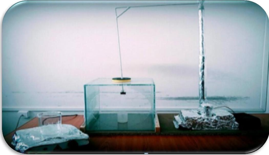
**Figure II.5:** Dispositif expérimental de trempage-tirage (*sol-gel*).
