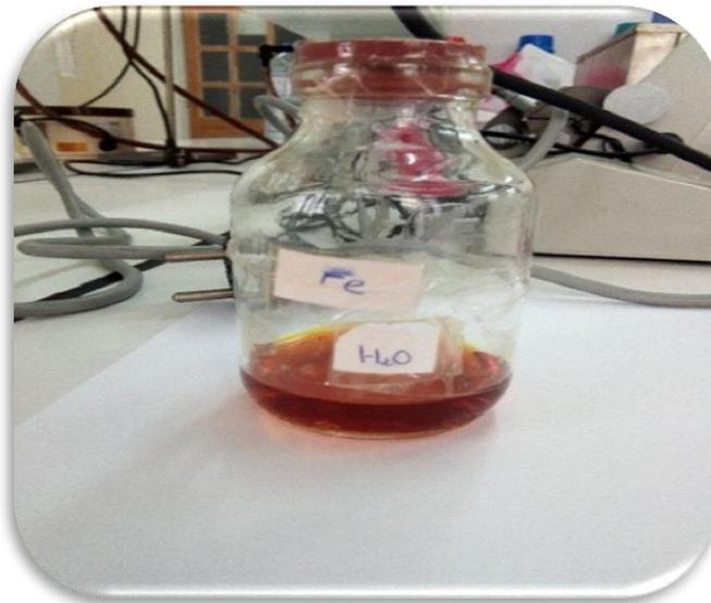
**Figure II.3:** Solutions préparées par la voie *sol-gel* pour obtenir des couches minces de  $\text{Fe}_2\text{O}_3$ .
