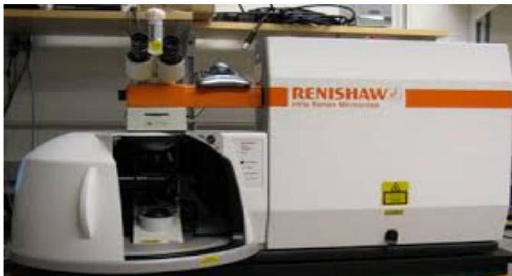
**Figure II.14:** Dispositif expérimental de la rétrodiffusion ( $\mu$ -*Raman*).
