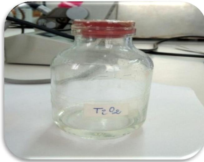
**Figure II.1:** Solution préparée par la voie *sol-gel* pour obtenir des couches minces de  $\text{TiO}_2$
