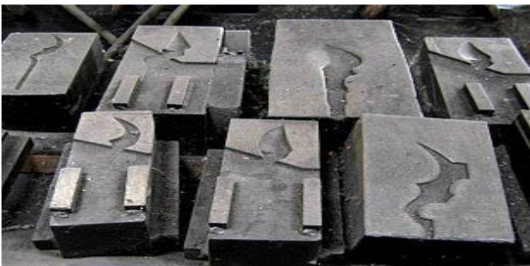
Figure 2.3 : Matrices d'outillage pour forgeage de sécateurs. XXe siècle
