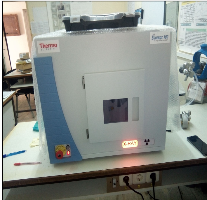
Figure 3.11 : Diffractomètre de type EQUINOX 100
