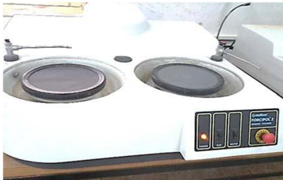
Figure 3.5: Polisseuse mécanique de type polisseuse (FORCIPOL 2)
