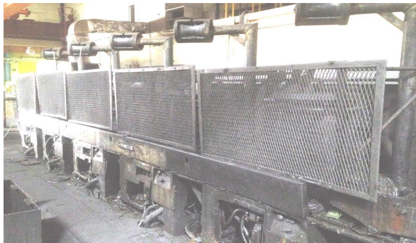
Figure2.9 : Schéma d'une machine à tréfilé multi-passe [29].
