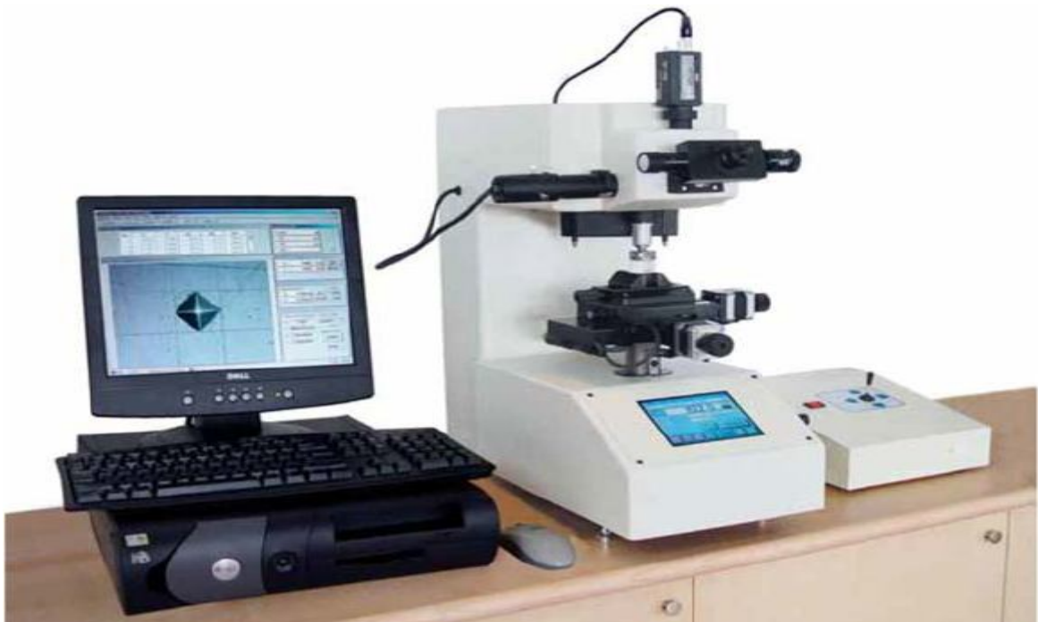
Figure.3.8 : micro-duremètre Vickers du type AFFRI
