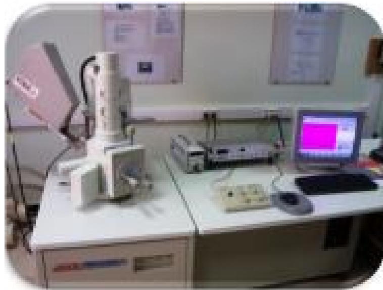
Figure 3.7 : Microscope Electronique à Balayage Jeol JSM 6360LV
