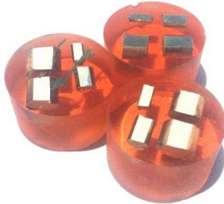
Figure 3.4 : Echantillons coupés et enrobés.
