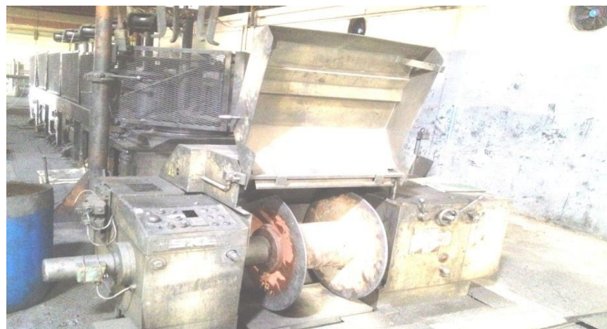
Figure2.10 : Machine de tréfileuses d'aluminium AGS (ENICAB Biskra).
