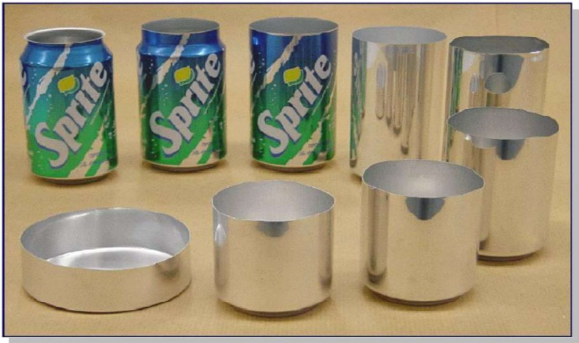
Figure II-4: Étapes de la production de canettes à partir de découpes circulaires par emboutissage profond, emboutissage de reprise et étirage de parois.
