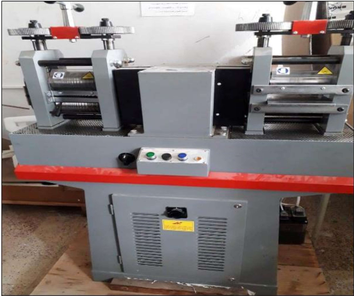
Figure III-3 : laminoir de type électrique 160 mm plaque + fil triphasé
