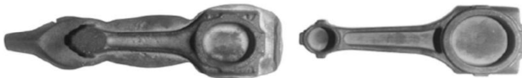
Figure II-2 : Comparaison forge conventionnelle, forge de précision [32]
