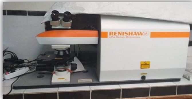
Figure II.16: Dispositif expérimental de la rétrodiffusion ( \mu -Raman).
