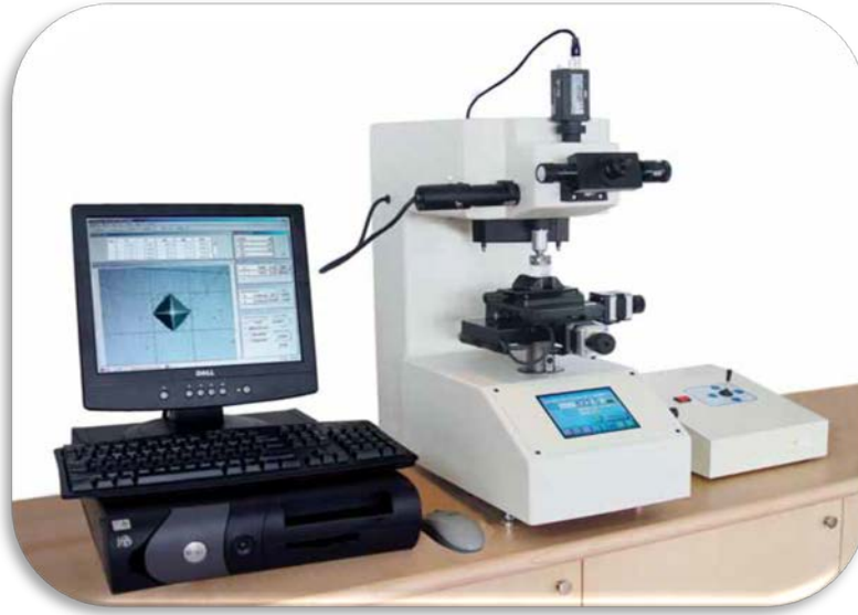
الشكل II.17: جهاز قياس الصلادة فيكرز نوع "AFFRI" (مختبر العناصر النشطة والمواد بجامعة العربي بن مهيدي أم البواقي)
