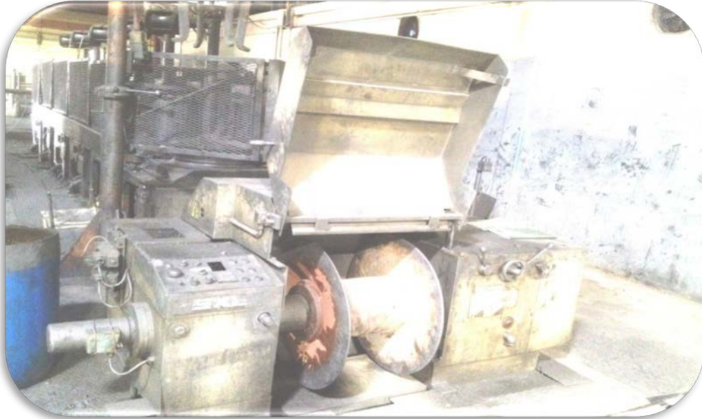
الشكل I.5 : آلة سحب الألمنيوم (ENICAB بسكرة).
