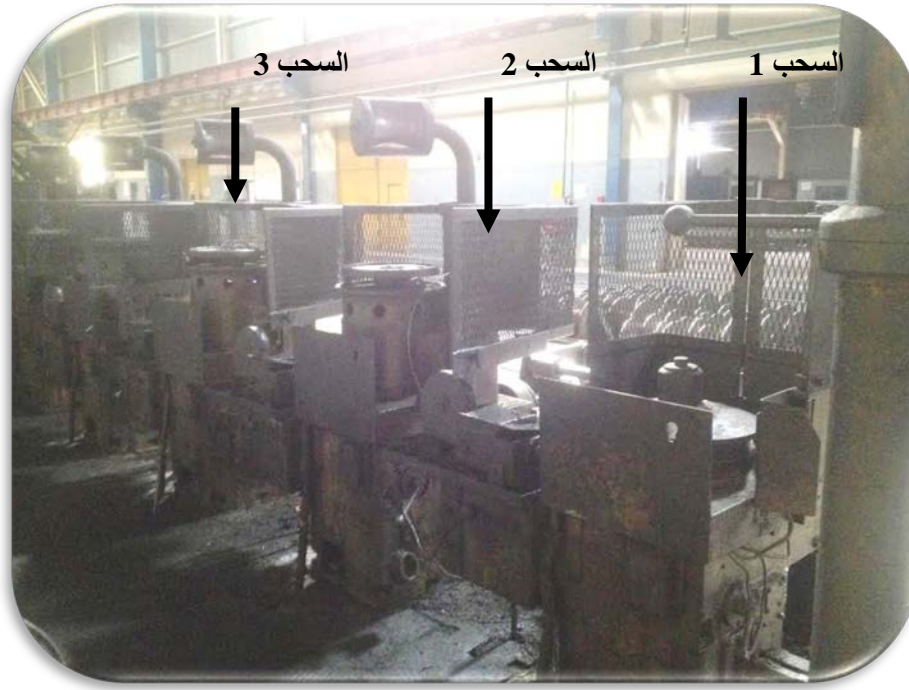
الشكل 8.II : مختلف عمليات سحب سبيكة الألمنيوم Al-Mg-Si (ENICAB بسكرة)
