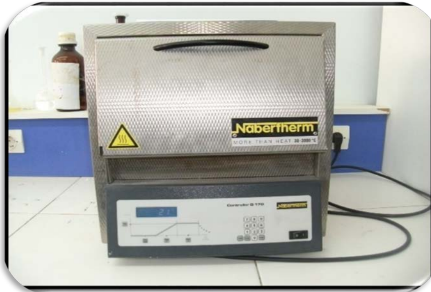
الشكل II.9: فرن لمعالجات الحرارية نابيرثرم NABERTHERM
