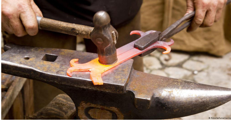
الشكل (8.II): عملية تشكيل المعادن بالحدادة.
