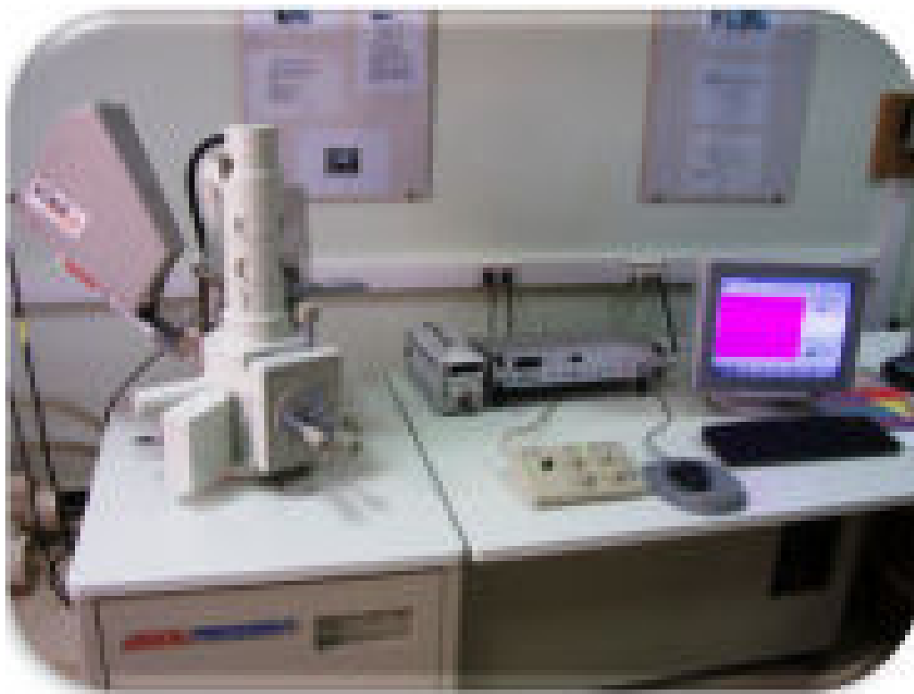
الشكل (15.III): المجهر الإلكتروني الماسح نوع Jeol JSM 6360LV (وحدة الأبحاث لتطوير
