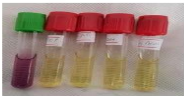
Figure 13 : Pouvoir antioxydant des extraits d'étude prouvé par le virement de DPPH en couleur jaune.
