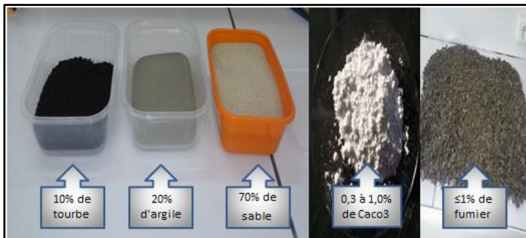
Figure16 : préparation de sol artificiel (photos personnelle).
