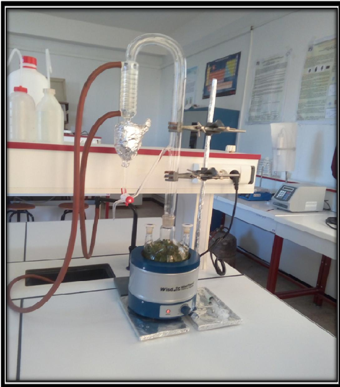
**Figure 06** : L'hydrodistillateur de type Clevenger (photo ; bilel).
