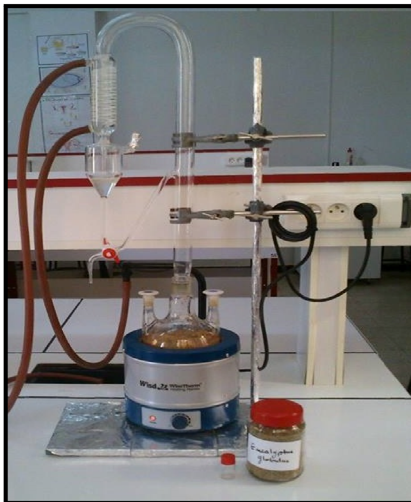
Figure 7 : Montage d'hydrodistillation (fouad et mohammed 2017).
