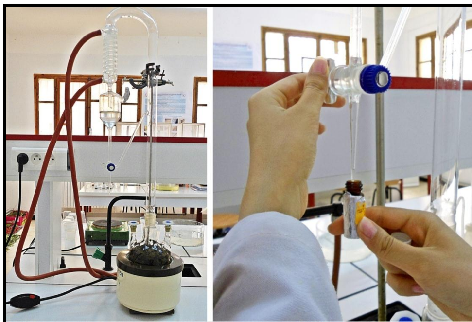
Figure 05: Montage de l'hydrodistillateur de type Clevenger.
