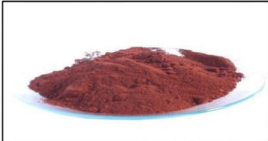
**Figure 15** : Les nanoparticules d'oxyde de fer en poudre.
