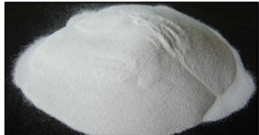
**Figure 16** : Les nanoparticules de dioxyde de silice en poudre
