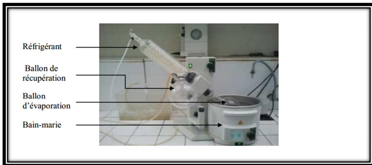
Figure14 : Evaporateur rotatif (Rihane et Benlahreche, 2013)
