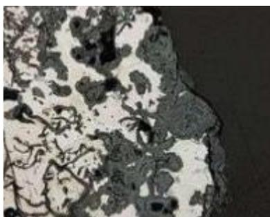
**Figure I.5.** Corrosion sélective.
