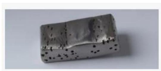
Figure I.1. Corrosion par piqûres [7].
