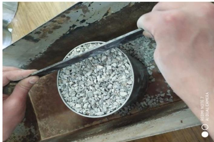
**Figure A. 9 : Essai de la masse volumique apparente**
