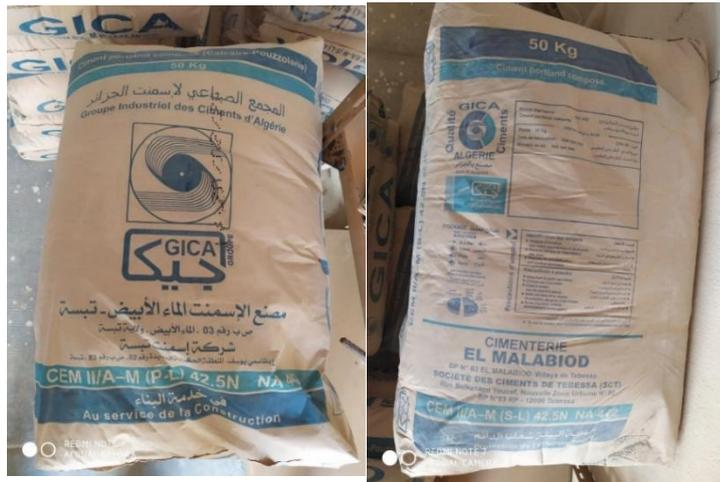
Figure A. 1 : Le ciment CPJ-CEM II/A M (P-L) 42,5 l'usine GICA (ELMALABIOD)
