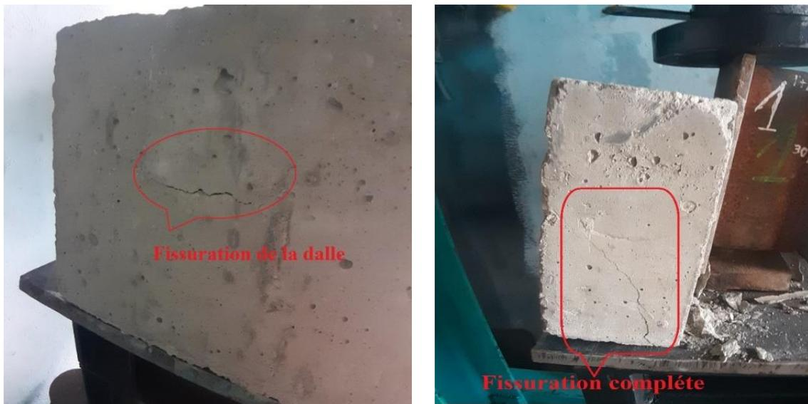
**Figure 2. 16 : Fissures dans les tests P01**
