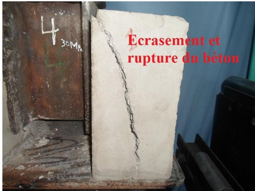
**Figure 2. 22 : Ecrasement du béton dans la position P04**
