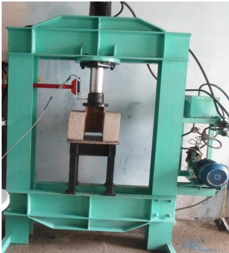
**Figure 2. 13 : Configuration de l'essai pushout**
