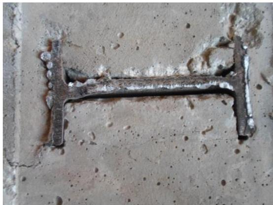
**Figure 3. 29** Déformation du connecteur en IPE120 dans la position P04
