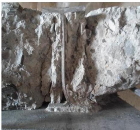
**Figure 3. 16 Déformation du connecteur dans la position P01 et rupture du béton**
