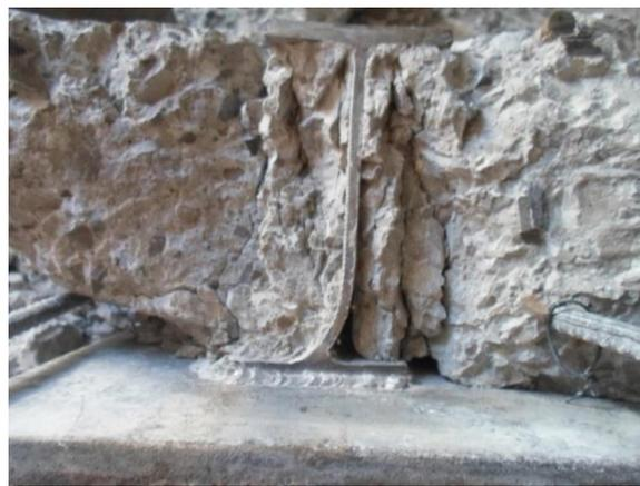
**Figure 2. 25 : Déformation du connecteur en position P01**
