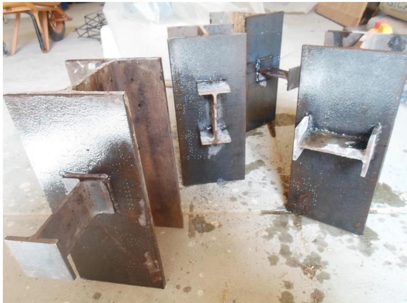
**Figure 2. 5 : Huilage de la poutre métallique**
