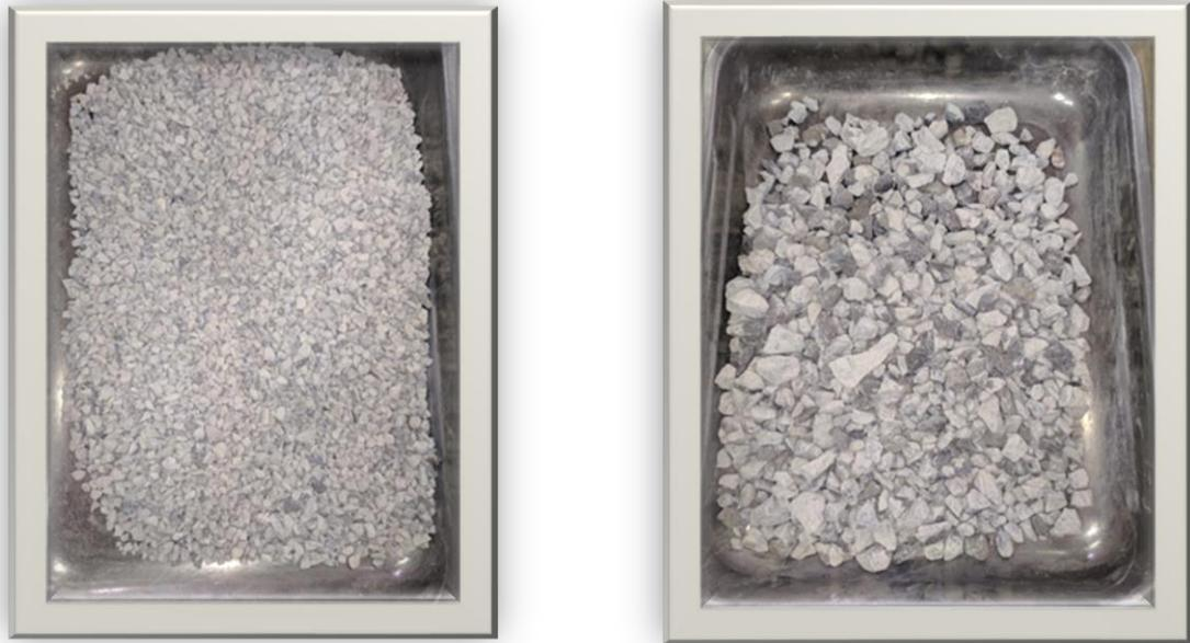
**Figure A. 3 : Échantillons des graviers 3/8 et 8/15**
