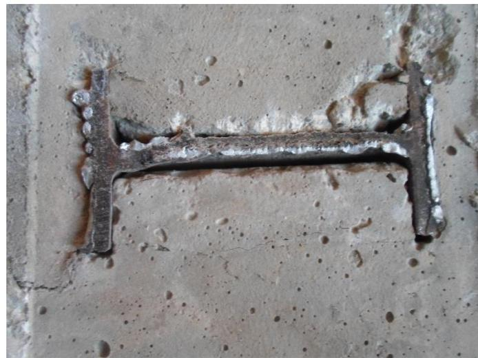
**Figure 2. 28 : Déformation du connecteur en position P04**
