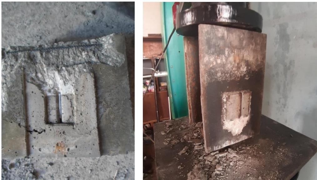
Figure 2. 18 : Cisaillement du connecteur dans la position P02
