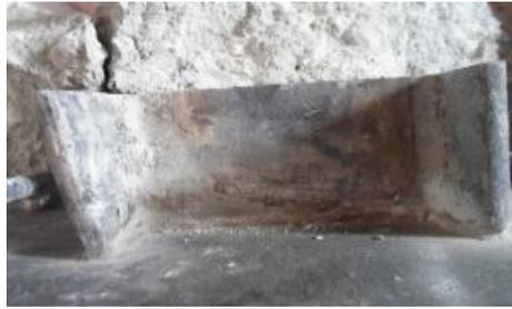
**Figure 3. 25 Déformation du connecteur dans la position P03**
