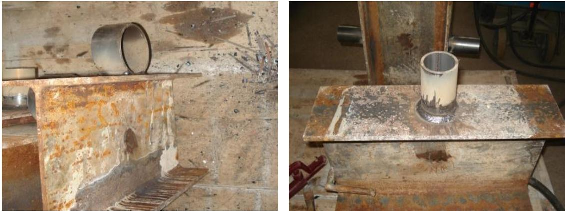
Figure 1. 19 Connecteurs en tubes d'acier [18]
