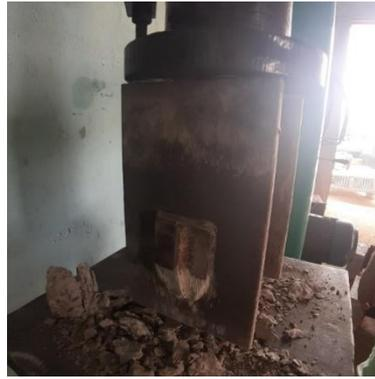
**Figure 3. 21 Cisaillement du connecteur dans la position P02**
