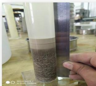
**Figure A. 8 : Mesure de la hauteur  $h_1$  et  $h_2$**
