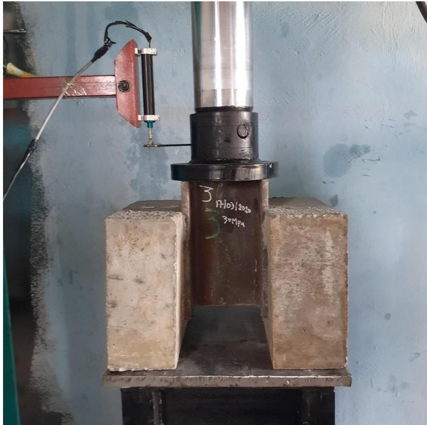
Figure 2. 14 : Mesure du déplacement
