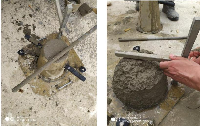
**Figure A. 11 : Essai d'affaissement au cône d'Abrahams.**
