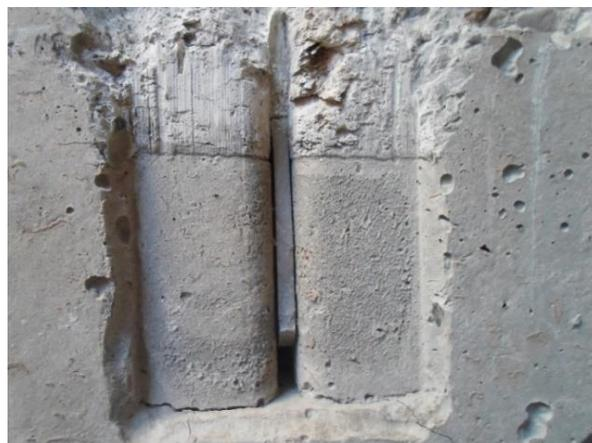
**Figure 2. 26 : Cisaillement du connecteur en position P02**
