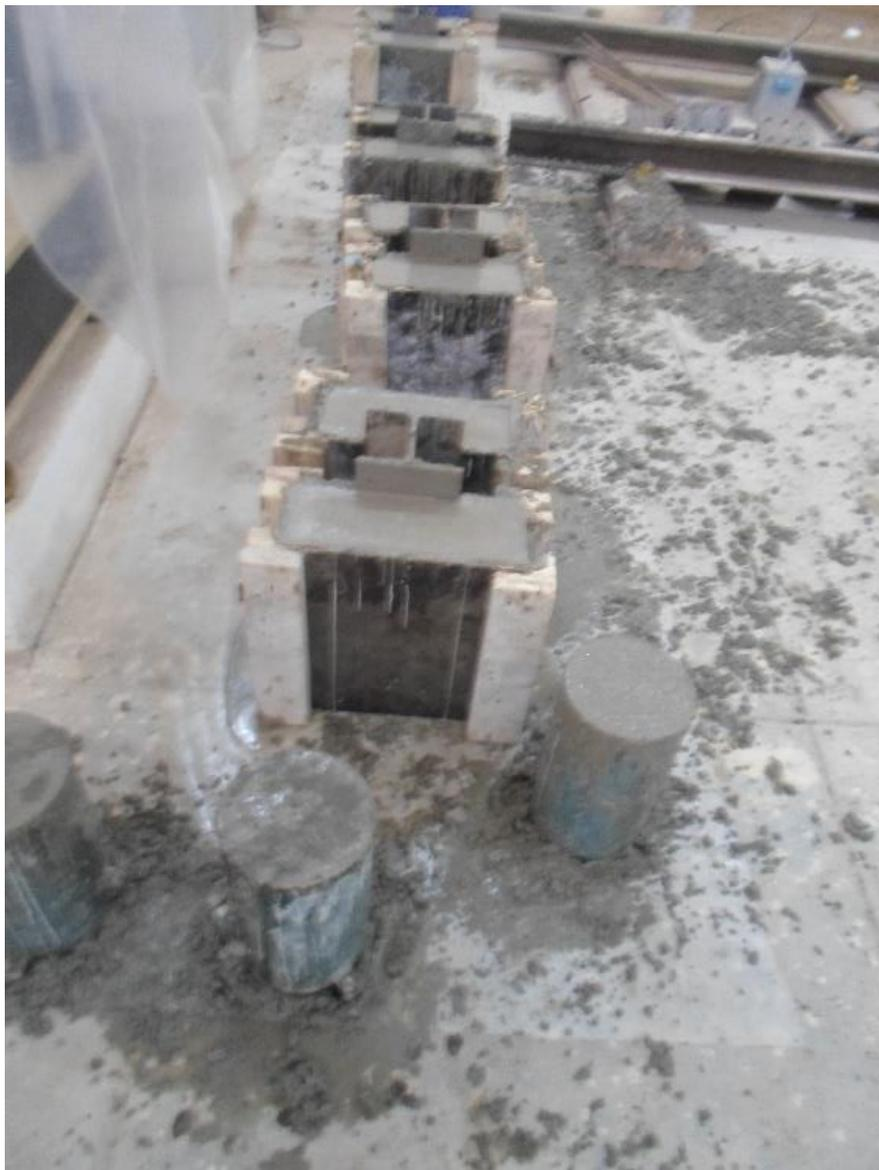
**Figure 2. 12 : Coulage des spécimens pushout**
