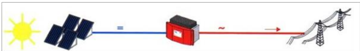
Figure II.20: principe d'un système photovoltaïque raccordé au réseau
