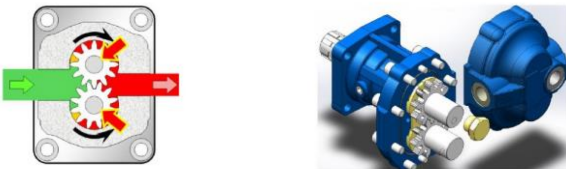
Figure 2. 4. Principe d'une pompe à engrenage
