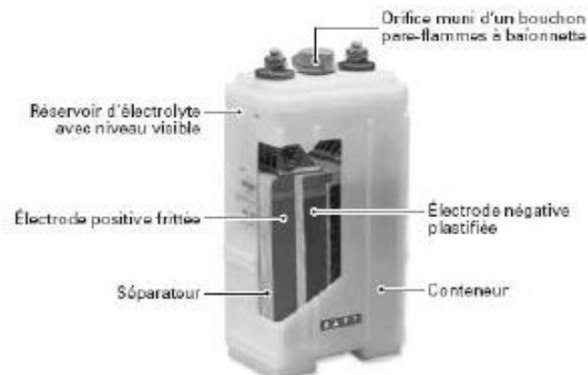
Figure. I.11 : Vue éclatée d'une batterie nickel-cadmium Ni-Cd industrielle [17].
