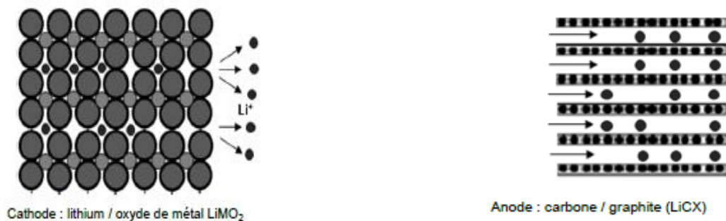
Figure. I.8 : schéma de principe de la batterie lithium-ion Li-ion[13].
