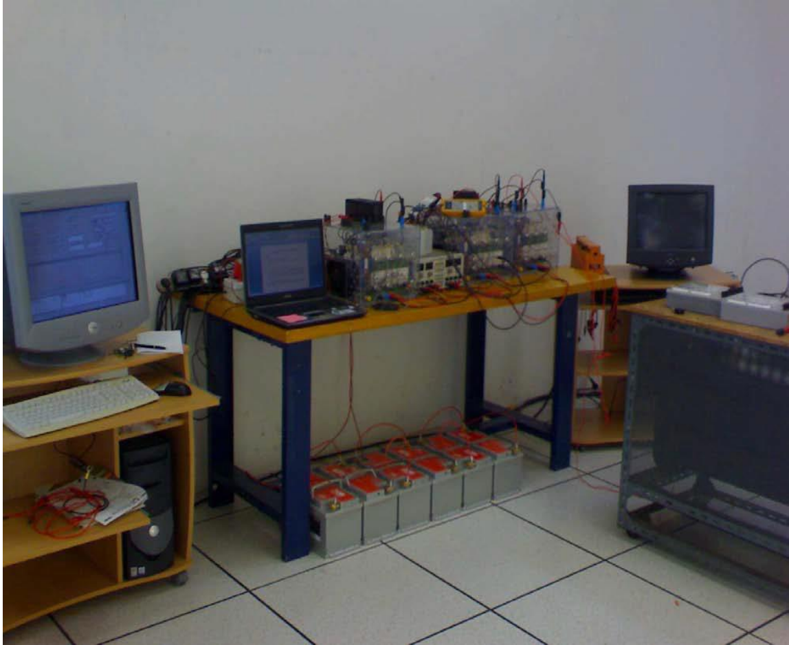
Figure. IV.6. Banc d'essai Système PV avec stockage (batteries plomb acide).
