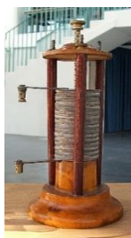
Figure. I.1 a) la pile de volta, b) la pile de Leclanché, c) la première batterie de Gaston planté
