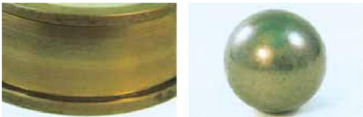
Figure 21 : taches et décoloration [10].
