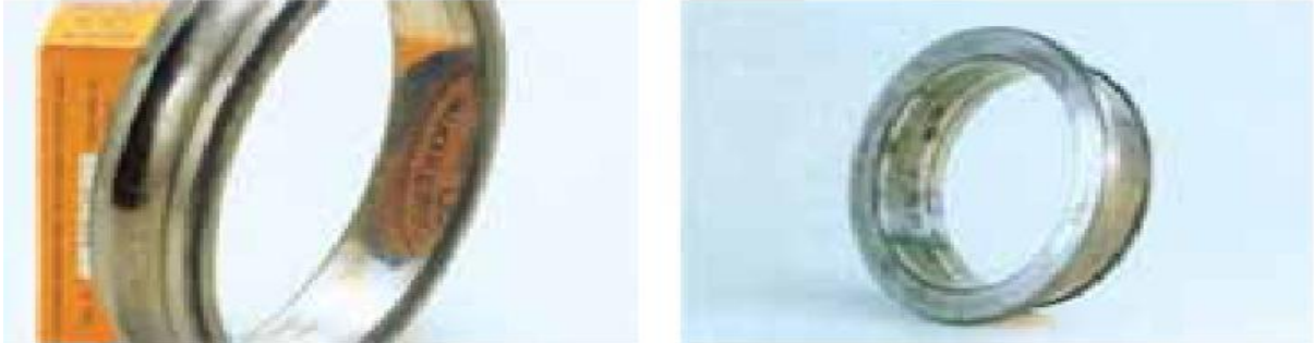
Figure 20 : rotation de bagues [10].
