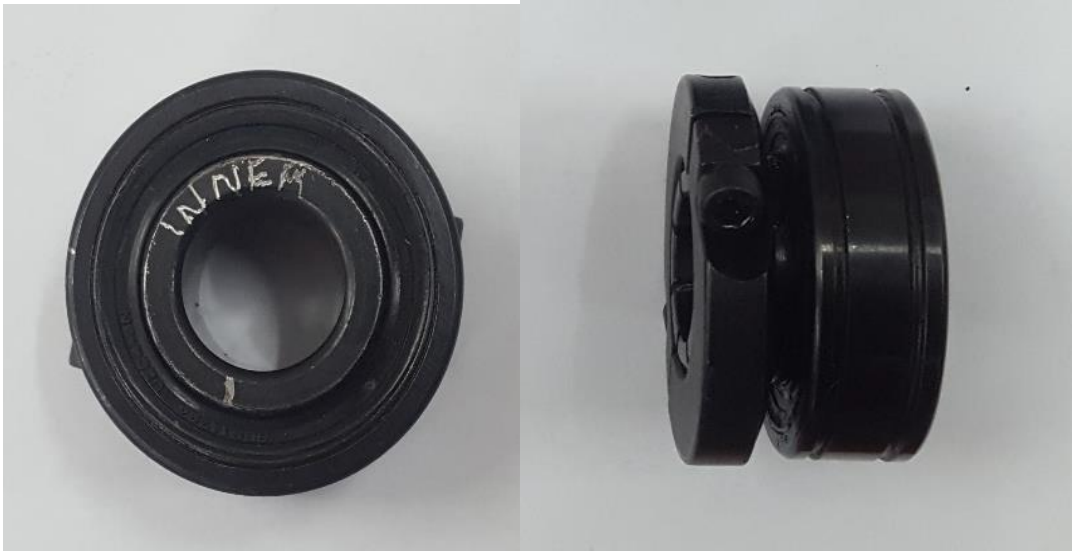
Figure 49 : Roulement avec défaut sur la bague intérieur.
