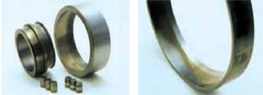
Figure 13 : Déformation du chemin de roulement [10].
