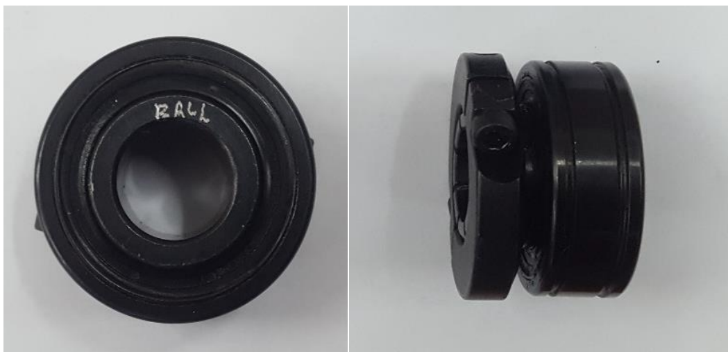
Figure 51 : Roulement avec défaut de bille.
