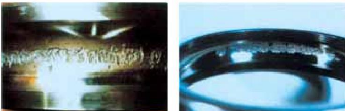
Figure 9 : l'écaillage des pistes [10]
