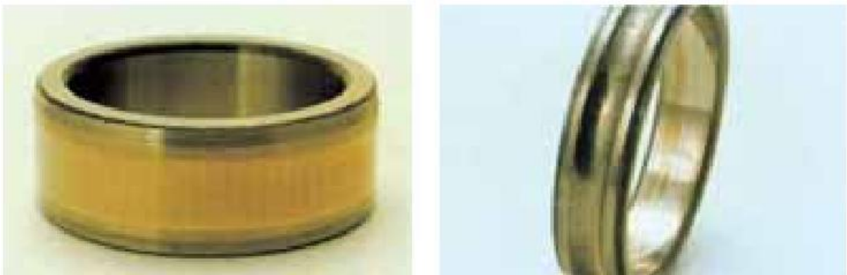
Figure 16 : corrosion de contact [10].
