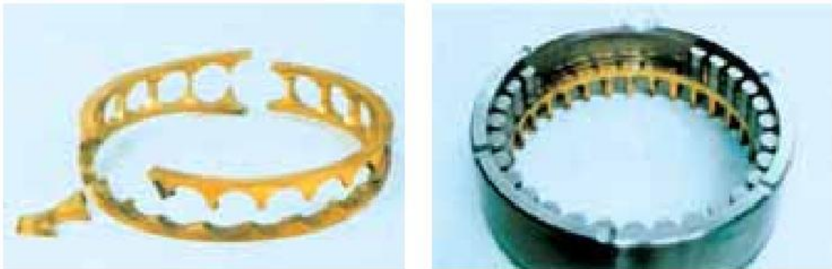
Figure 12 : Détérioration de cage [10].
