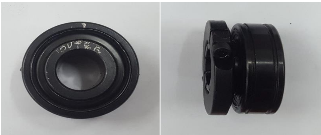
Figure 50 : Roulement avec défaut sur la bague extérieur.
