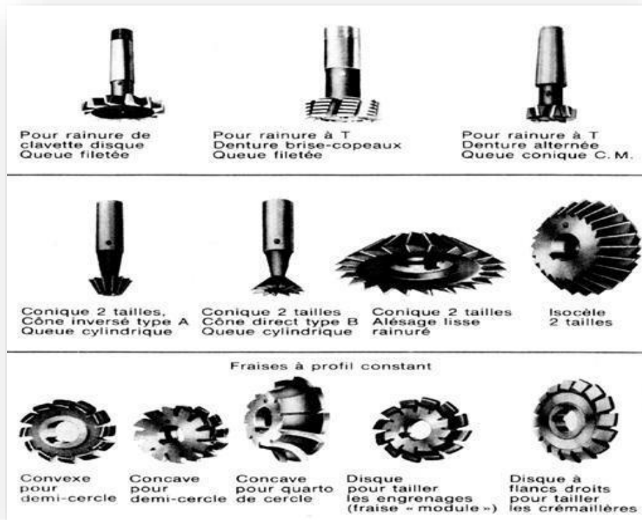
Fig. III.15 : types des fraises [45].
