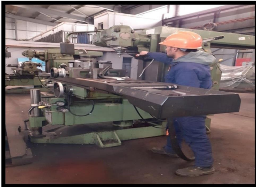
Fig. IV.2 : Fraiseuse universelle FU-1800 [60].
