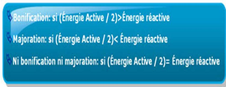
**Figure (II.4)** facturation de l'énergie réactive
