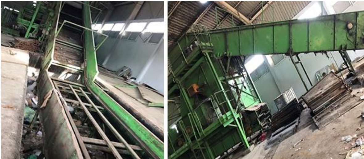
Figure III.33 : chaîne de tri défaillante
