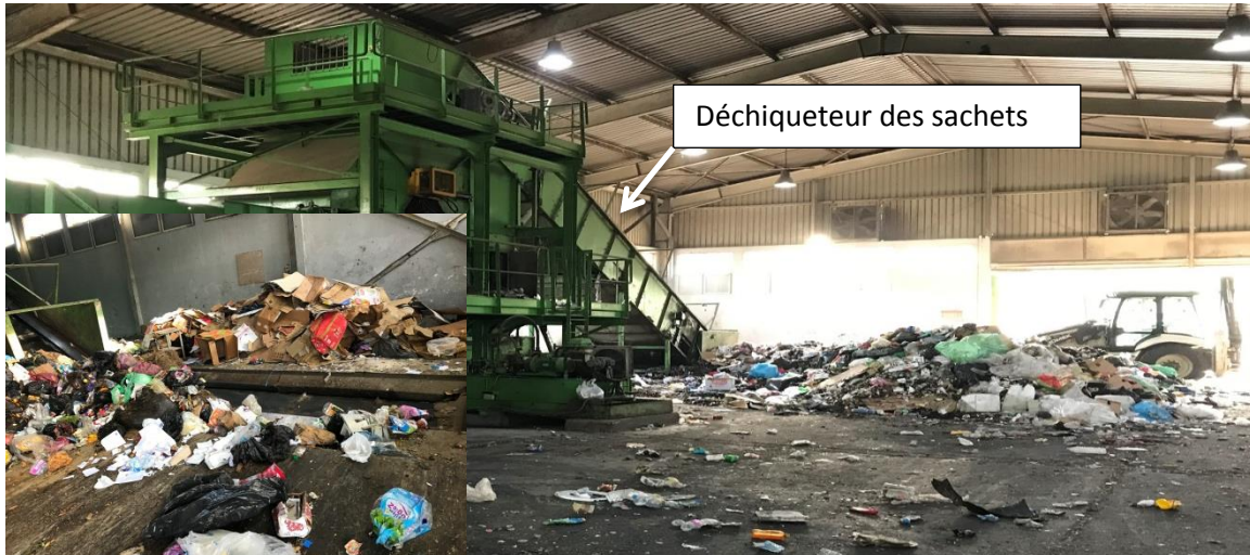
Figure III.19 : l'alimentation de la chaîne de tri par un chargeur
