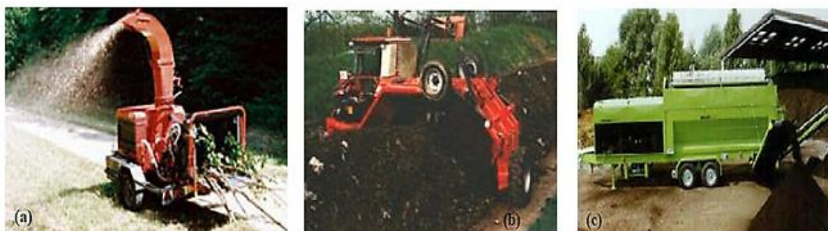
Figure II.56 : (a) Broyeur, (b) Retourneur d'andain, (c) Crible (trommel rotatif, tamis à disques, tamis vibrants). [21]
