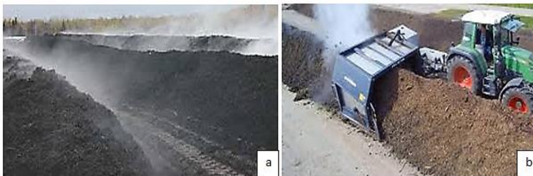
Figure II.55 : (a) Opération de compostage en andains, (b) Engin utilisé pour aérer le compost mis en andains. [21]
