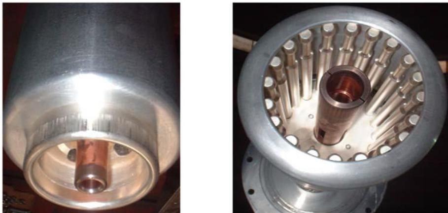
**Figure II.13.** Système de contact de type tulipe [17]
