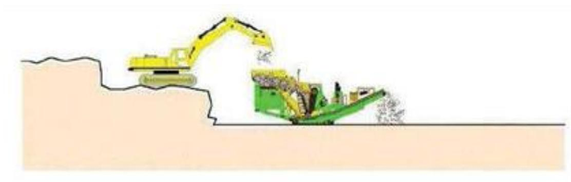
**Figure III.12.** Pelle et concasseur mobile [8].
