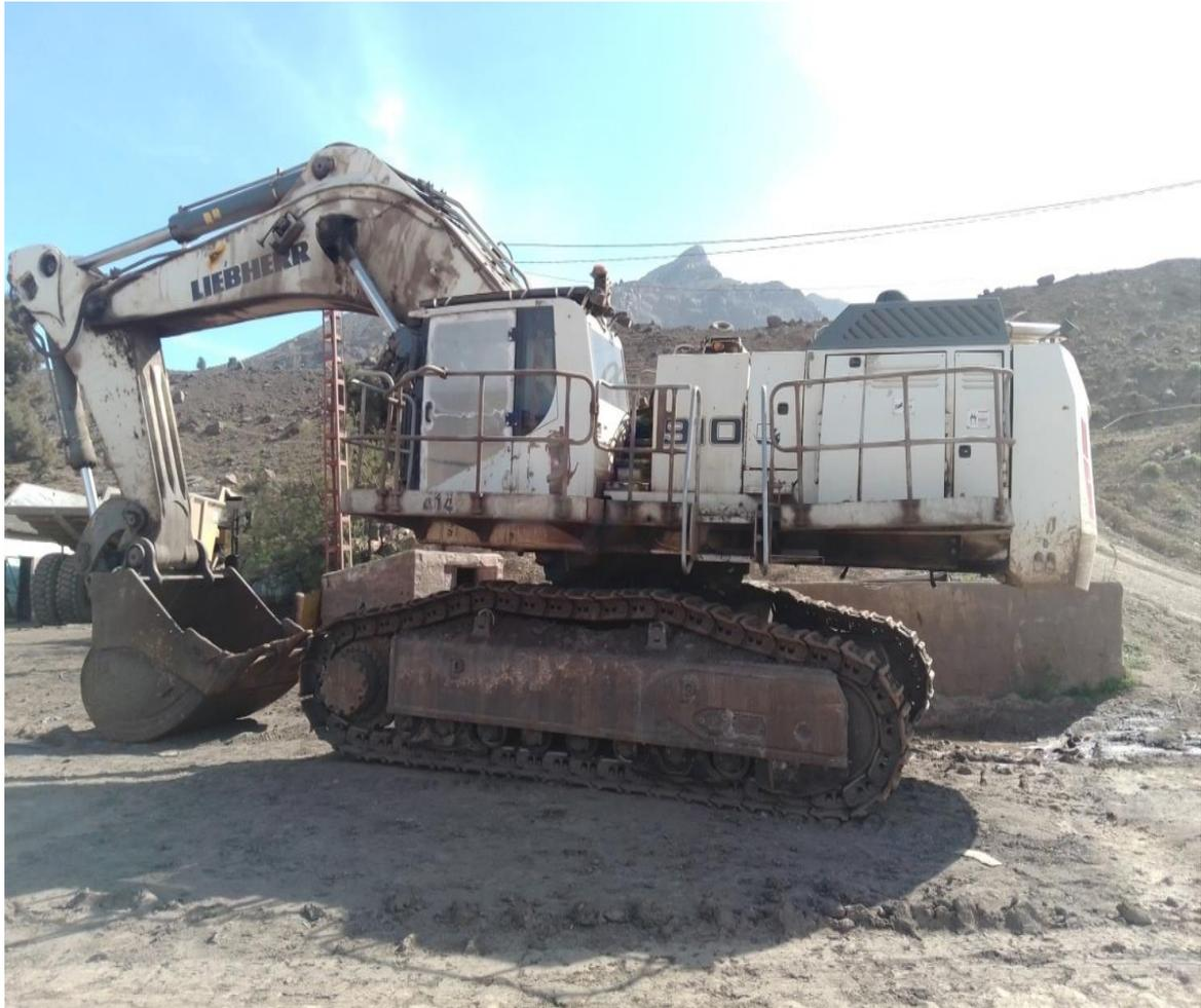
**Figure IV.3.** Pelle hydraulique LIEBHERR 9100.
