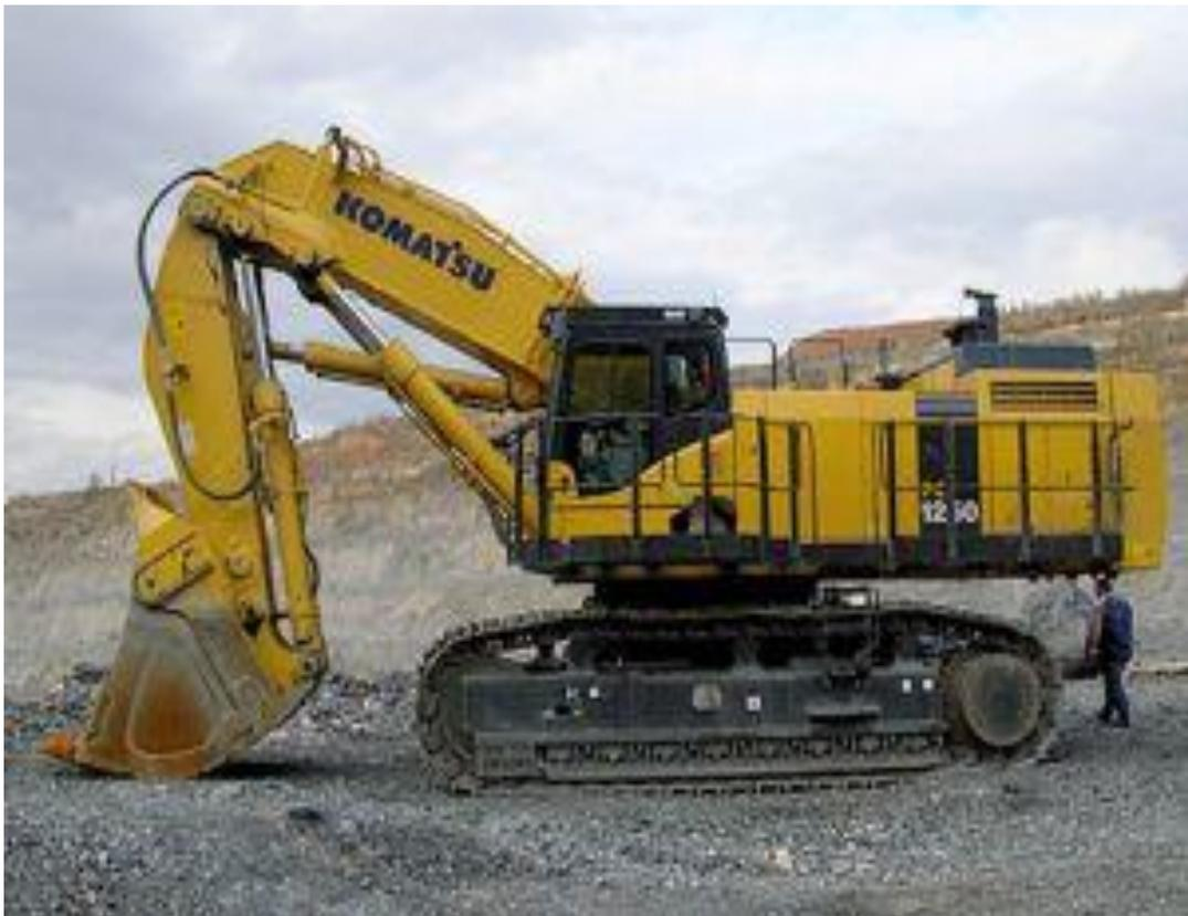
**Figure IV.2.** Pelle hydraulique KOMATSU pc 1250
