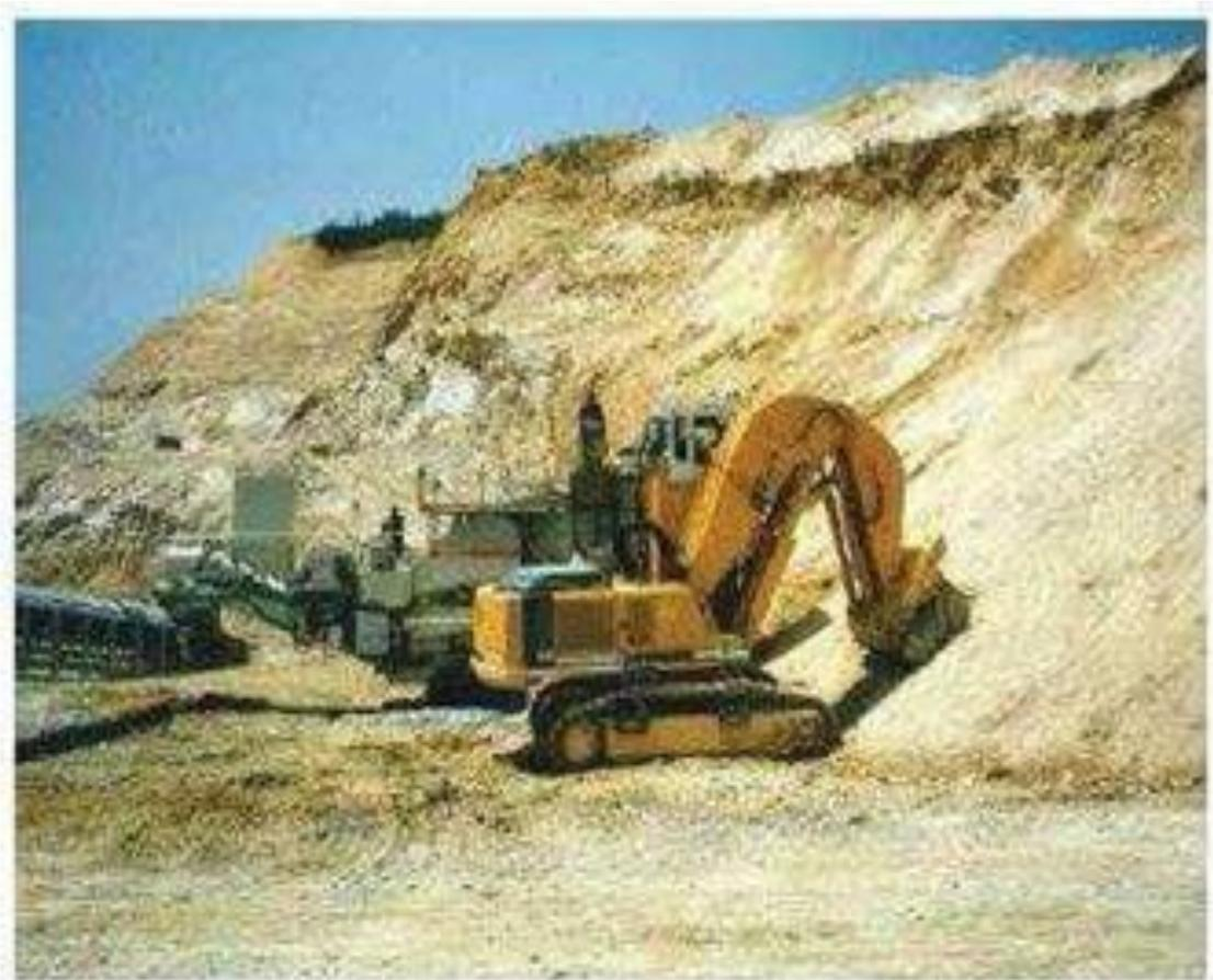
**Figure III.13.** Pelle et concasseur mobile [8].
