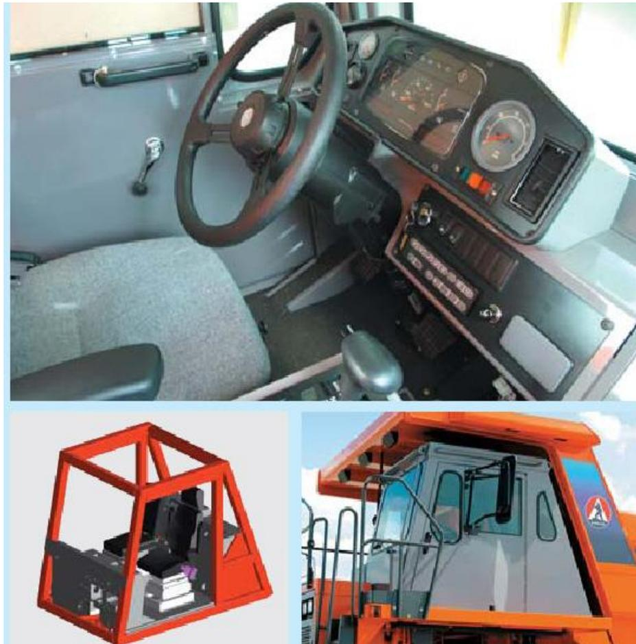
**Figure II.10.** Poste de commande [9].
