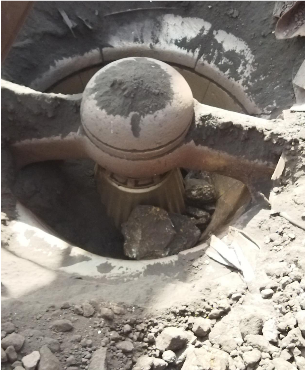
Figure II.12 Le concasseur giratoire de la mine Boukhadra.
