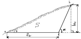
Figure. II.1.7. Section de la demi-tranchée d'accès
