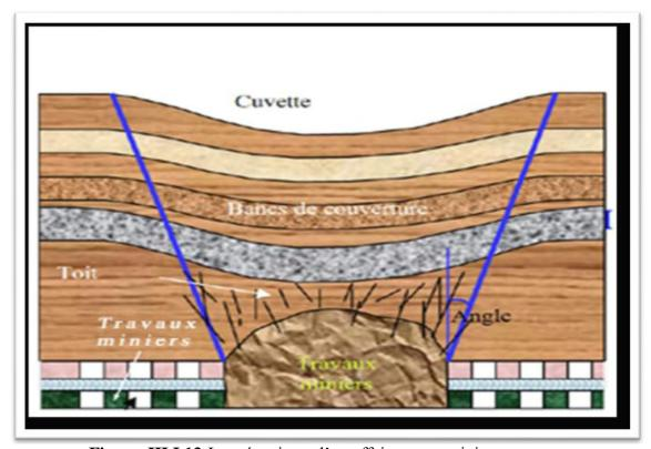
Figure .III.1.13:Le mécanisme d'un affaissement minier.
