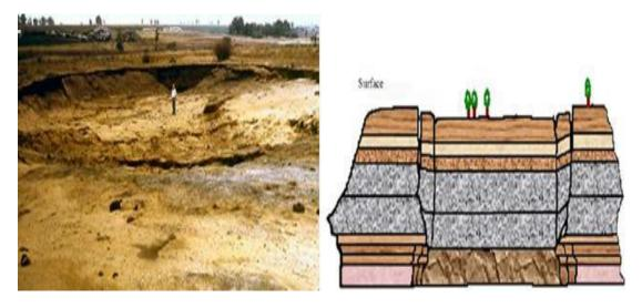
Figure .III.I.11: Effondrement généralisé
