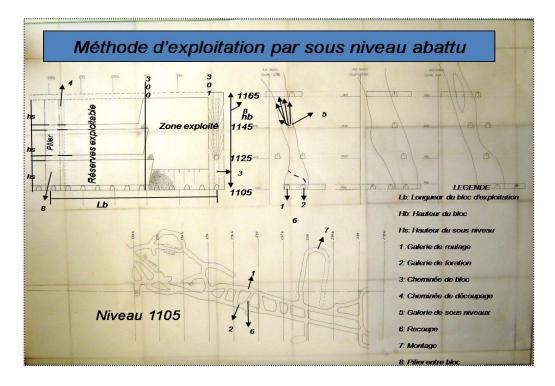
Figure .II.2.3: Représente la méthode d'exploitation par sous niveau abattu
