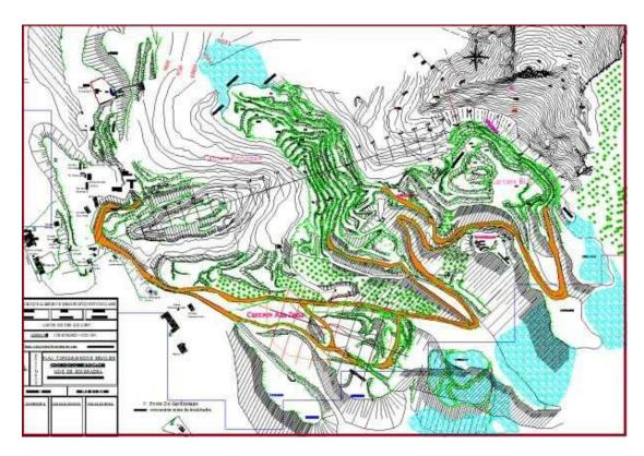
Figure. II.1.9. Plan d'ouverture de la mine de Boukhadra.
