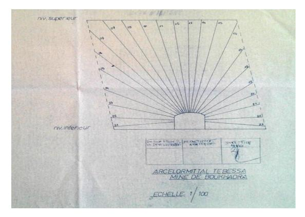
Figure .II.2.4 : Schéma du plan de tir souterrain
