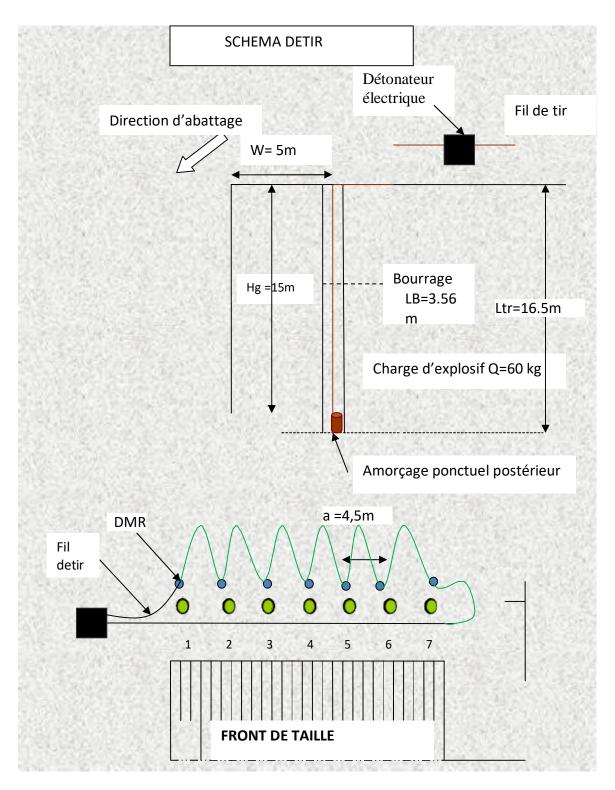
Figure II.1.14. Schéma du Plan de tir.
