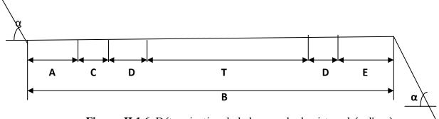
Figure. II.1.6. Détermination de la largeur du demi-tranchée d'accès.
