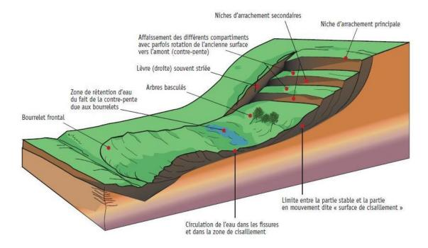
Figure .III.I.1: Processus de glissement de terrain.
