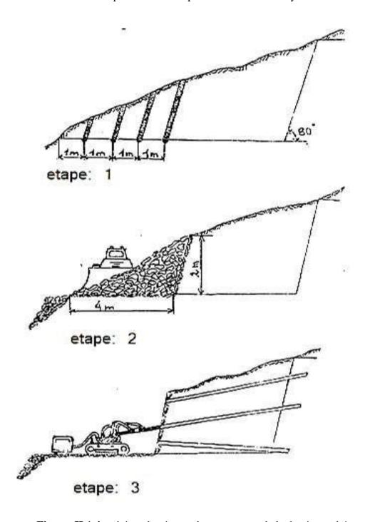
Figure .II.1.4: schéma des étapes de creusement de la demi-tranchée
