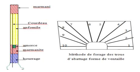
Figure .II.2.5 : Méthode de forage des trous d'abattage forme de ventaille
