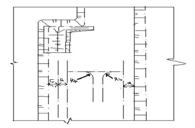
**Figure. II.1.8.** Paramètres de la largeur de la demi-tranchée de découpage.  $\alpha_d$ : Angle du talus du bord de la tranchée de découpage  $\alpha_d$ =80°. L: Longueur de la demi-tranchée d'accès ;L=1300 m.
