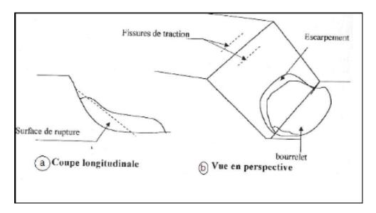
**Figure .III.I.3:** Glissement rotationnel simple.
