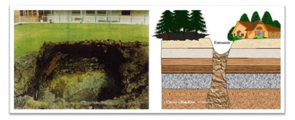
Figure .III.I.12: Exemple d'un effondrement localisé
