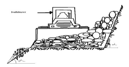
Figure .II.1.5:4<sup>eme</sup> étapes de creusement de la demi-tranchée d'accès
