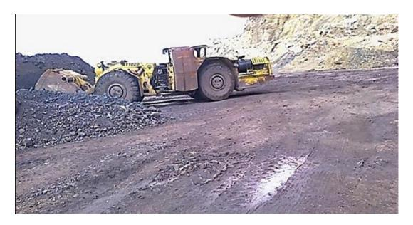
Figure .II.2.6: chargeuse transporteuse pneumatique type ATLAS COPCO St 1020.
