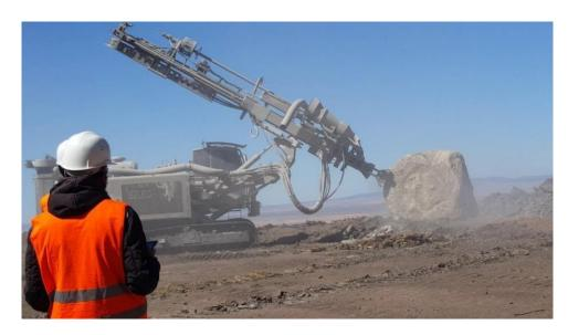
**Figure. II .1.13.**la sondeuse BBURG HD1500D utilisé pour les travaux de forage au niveau de la mine de Boukhadra
