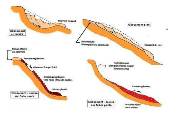
**Figure .III.I.4:** Quatre schémas de différents types de glissement de terrain en fonction de la typographie.
