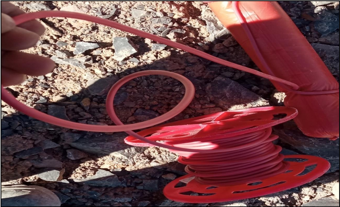
Figure I.1. Le cordeau détonant.
