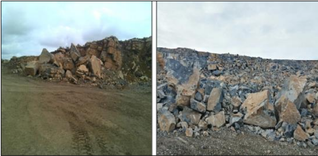
Figure V.13. Présence de hors gabarit
