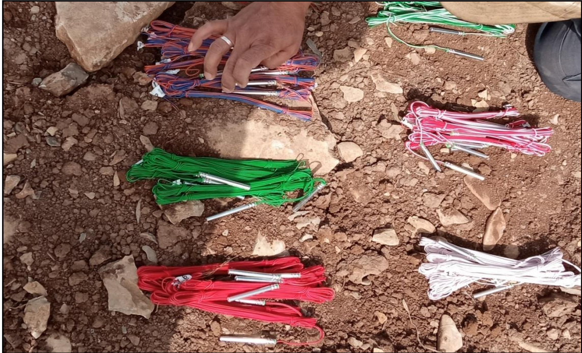
Figure I.2. Le détonateur pyrotechnique microretard (DMR)
