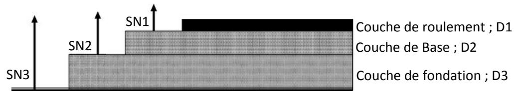
**Figure 3.19** Procédure de détermination des épaisseurs des couches
