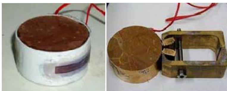
Figure 2.16 Photos de la cellule œdométrique flexible conçue par Windal (Windal, 2001)
