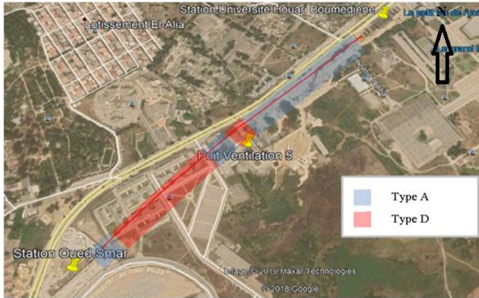
Figure III.15. Identification de types de sensibilité le long de la section (Google Earth).
