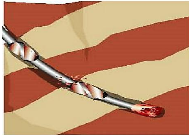
Figure.IV.04 : formation du Dog leg (Naim et al., 2010).
