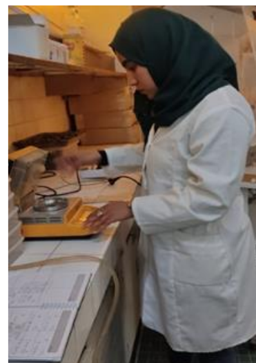
Fig.22 : Mesure de H 2 O avec une balance de mesure d'humidité
