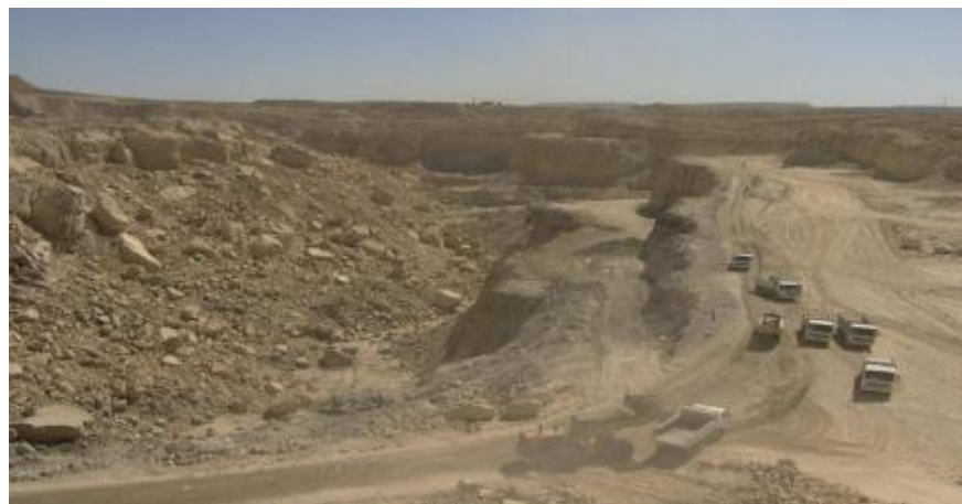
Fig. 37 : La nouvelle tranchée d'accès pour suite de l'exploitation
