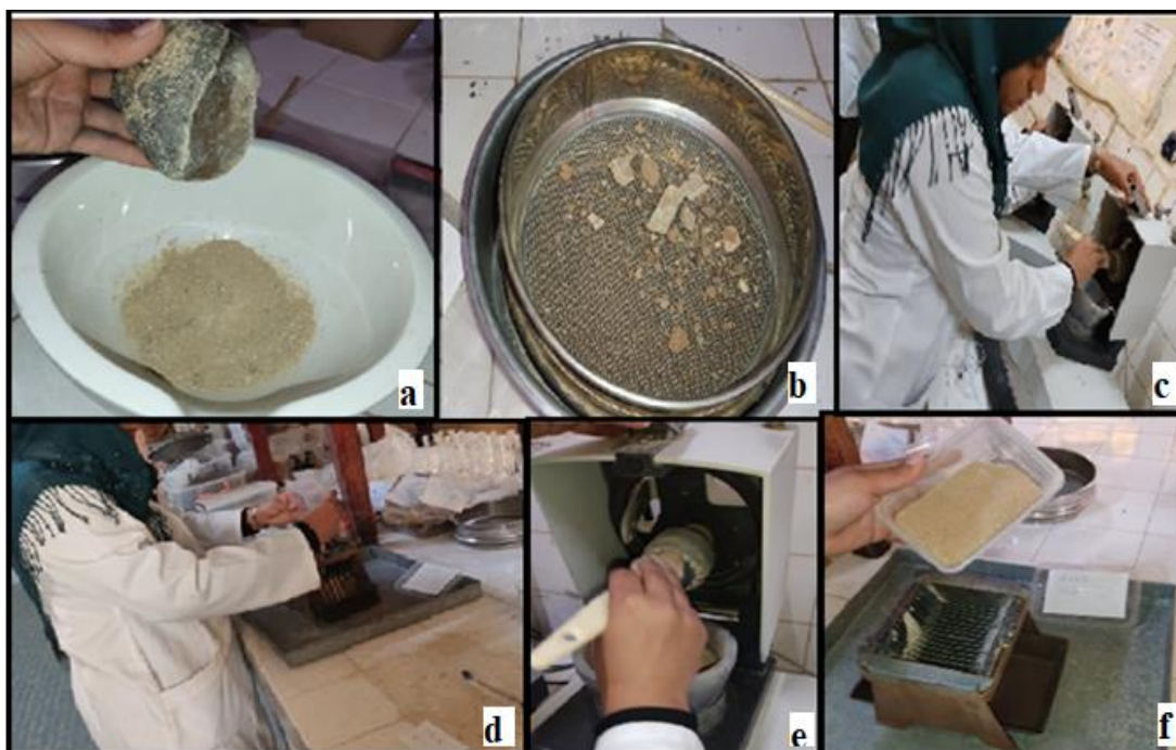
Fig. 20 : préparation mécanique des échantillons : a) concassage, b) tamisage, c) broyage, d) division d'échantillon, e) récupération d'échantillon, f) diviseur.
