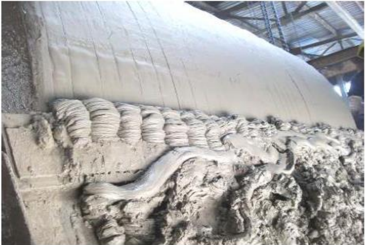
Figure I.19: Filtration de concentré de flottation de blende Zn.
