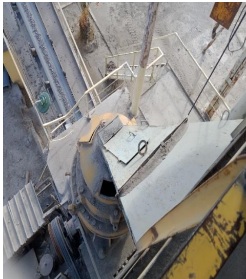
Figure I.14 : Vue de la section concassage à cône, Kherzet Youcef 2021
