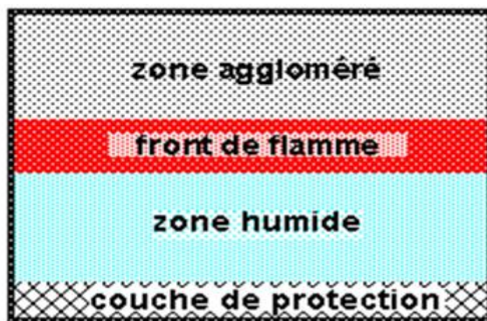
Fig.V.5. Section verticale d'une couche en cours d'agglomération
