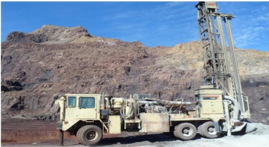
Fig. I.10. La sondeuse INGERSOLL-R(T4BH900HR4) en travail de mine de l'Ouenza. [5]
