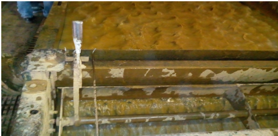
Figure II.02 : séparation gravimétrique du minerai barytique de Bou-Caid-Algérie
