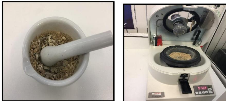
**Figure 18.** Broyage des escargots lyophilisés à l'aide d'un mortier et un broyeur mécanique (FRITSCH Pulverisette 2) (Photos personnelles).
