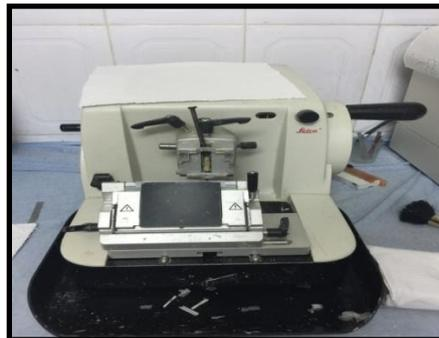
**Figure 9.** Coupe des blocs des échantillons à l'aide d'un microtome Leica (Photo personnelle).
