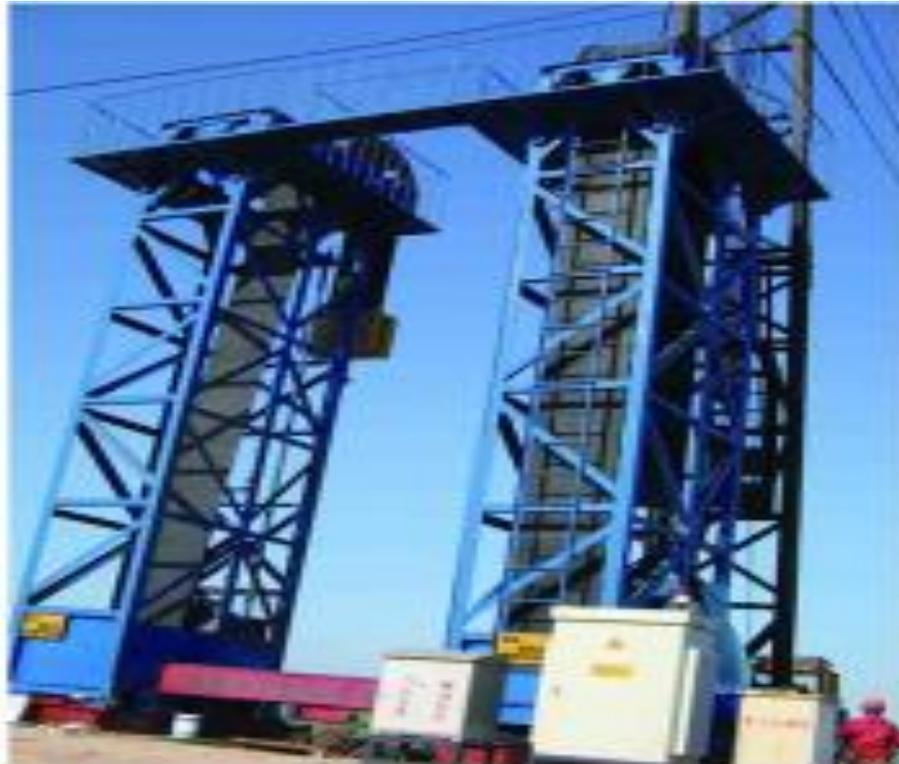
▪ **Figure 1. 8 Système de pompage pétrolier entraîné par MRV**
