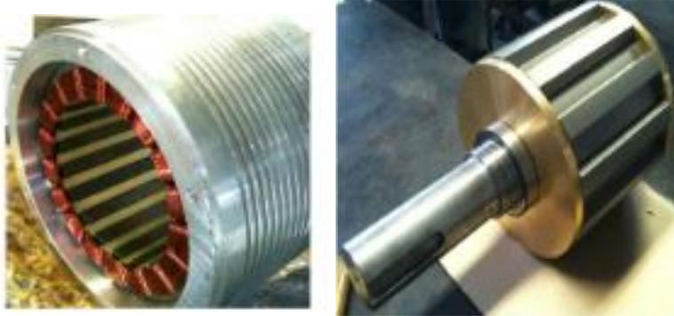
Figure 1. 16 Prototypage de la structure du MRV pour la traction du VE [19,20]
