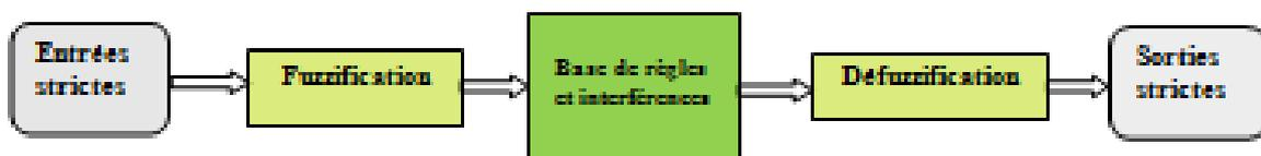
Figure 3. 18 Structure d'un contrôleur flou
