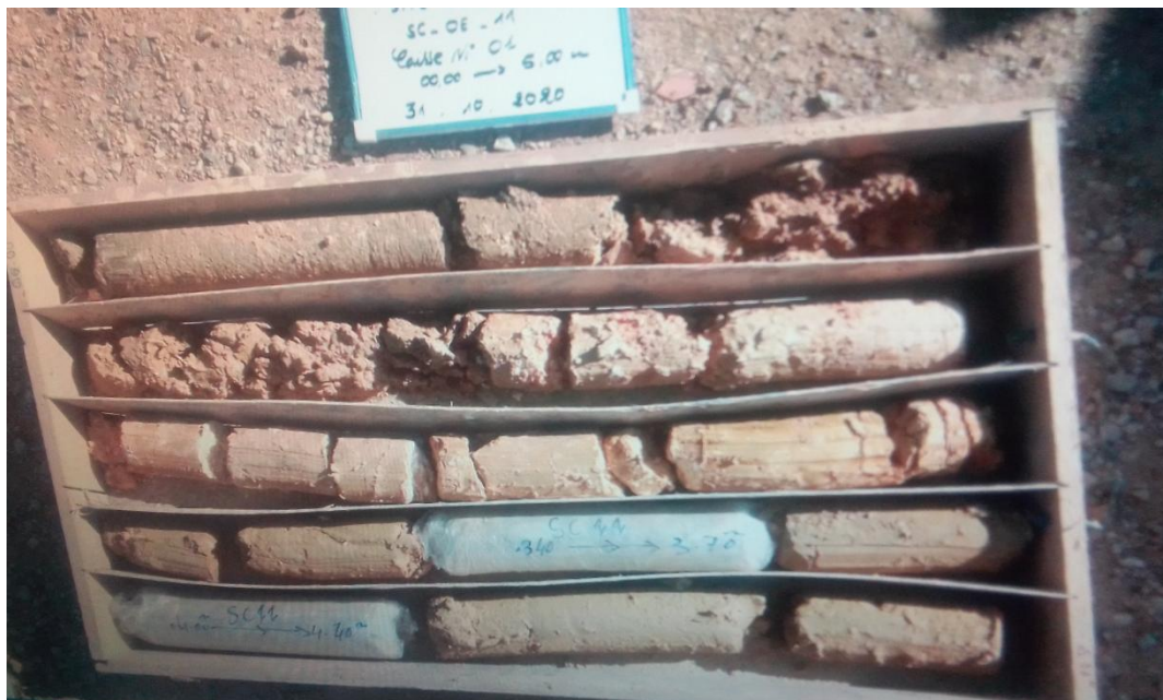
Figure 38 : Échantillon des sondages carottés SC-OE-11, Caisse N°01.
